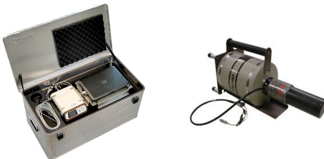
Obr. 7 Letecký spektrometr s polovodičovým detektorem HPGe Ortec, účinnost 25 %
