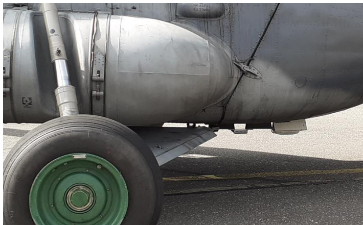
Obr. 9 Umístění radarového výškoměru v zadních "krovkách" vrtulníku Mi-17
