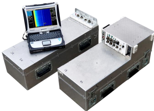
Obr. 5 Letecký spektrometr IRIS (výrobce Pico Envirotec, Canada), 2 boxy, 4 detektory NaI(Tl) s rozměry krystalů 40.6 cm x 10.2 cm x 10.2 cm
