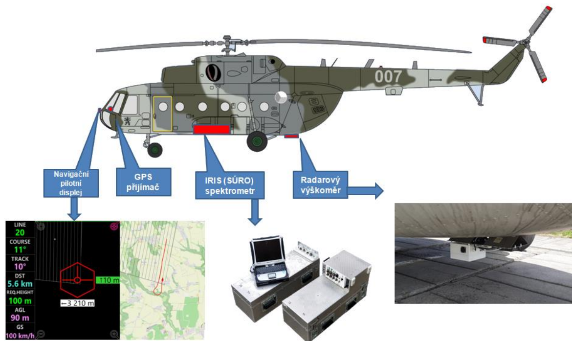
Obr. 11 Umístění leteckého spektrometru a dalšího příslušenství na vrtulníku Mi-17
