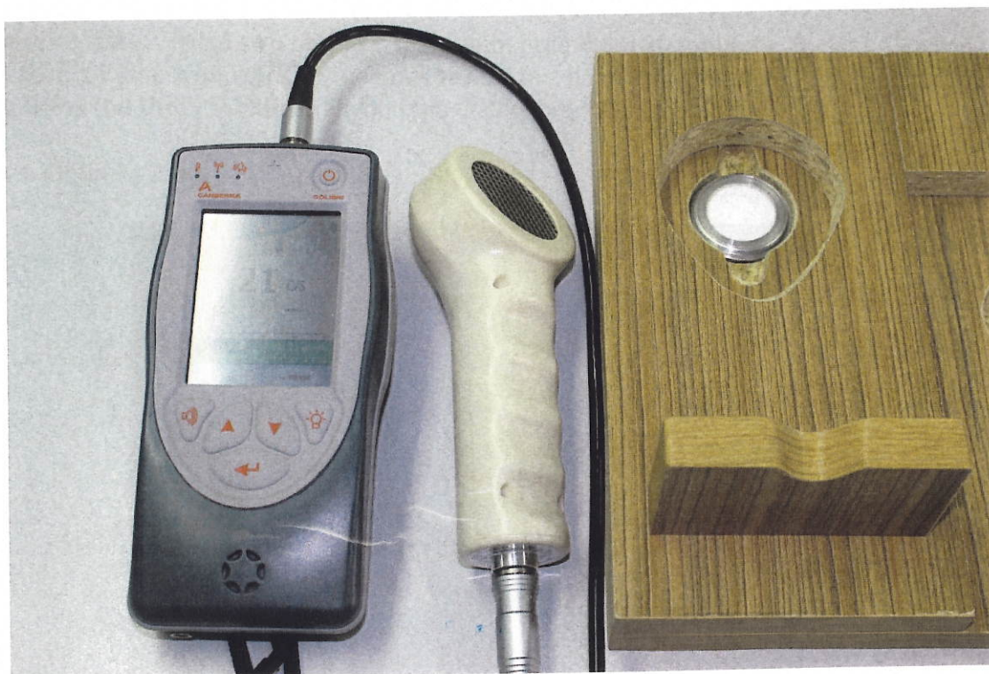
4) Na obr. 5 je zobrazeno umístění měřicí sondy do „držáku filtru“ Obr. 5 Umístění sondy do „držáku filtru“
