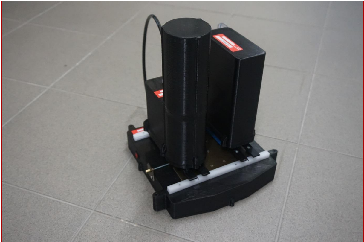
Obr. 2 Podvěs bezpilotního leteckého prostředku s multifunkčním detekčním zařízením - ilustrační foto
