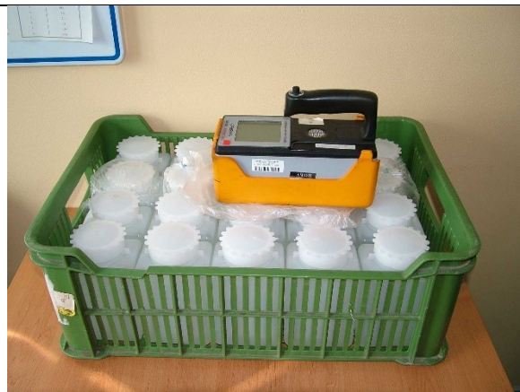
Obr. 7 Geometrie měření přepravky shora
