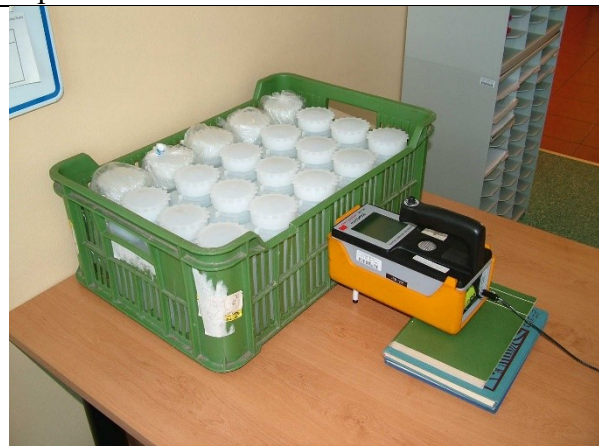
Obr. 6 Geometrie měření přepravky zepředu
