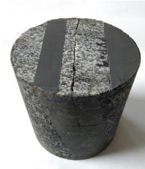
Obr. 3 Vlevo: příprava vzorku pro fixaci epoxidem, vpravo: zpevněný vzorek
