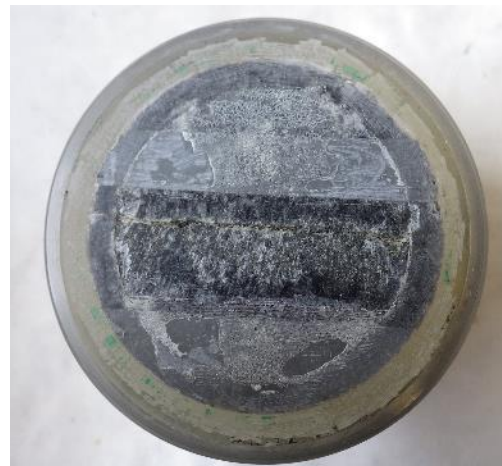
Obr. 4 Vlevo: upínací zařízení pro zalévání vzorku pryskyřicí, vpravo: vzorek po vytvrdnutí pryskyřice
