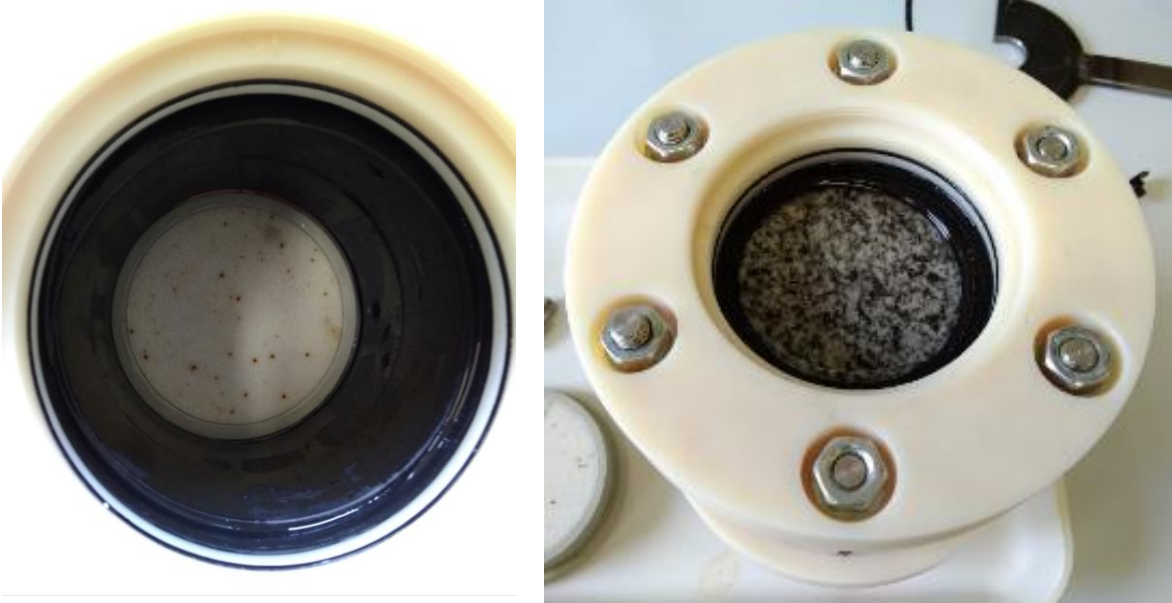
Obr. 9 Vlevo: pohled do vnitřního prostoru experimentální cely s napnutou pryžovou membránou a porézní destičkou, vpravo: experimentální ceta s vložených horninovým vzorkem s puklinou
