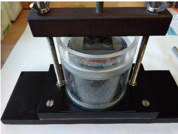
Obr. 4 Vlevo: upínací zařízení pro zalévání vzorku pryskyřicí, vpravo: vzorek po vytvrdnutí pryskyřice
