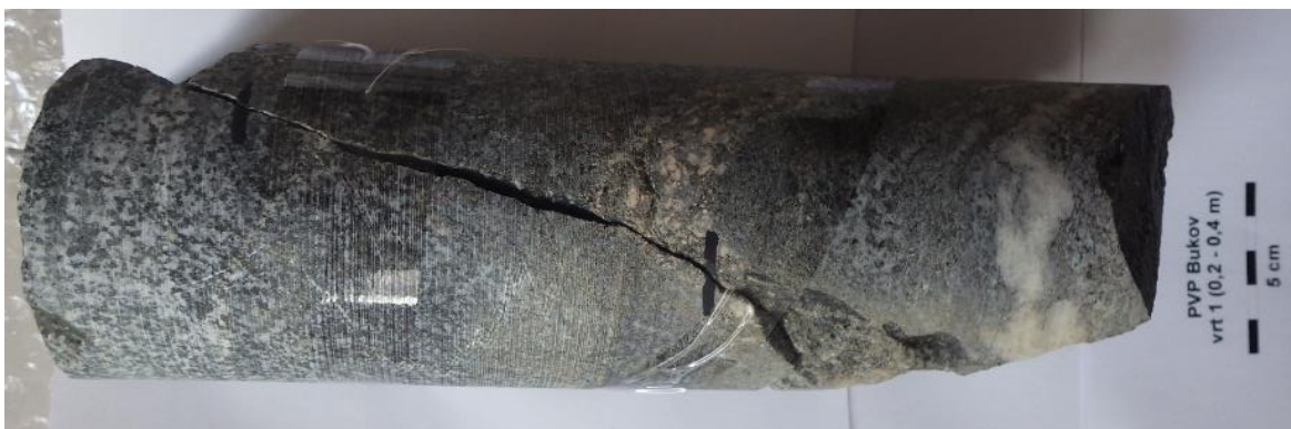
Obr. 1 Část vrtného jádra s puklinou použitá pro výrobu fyzikálního modelu
