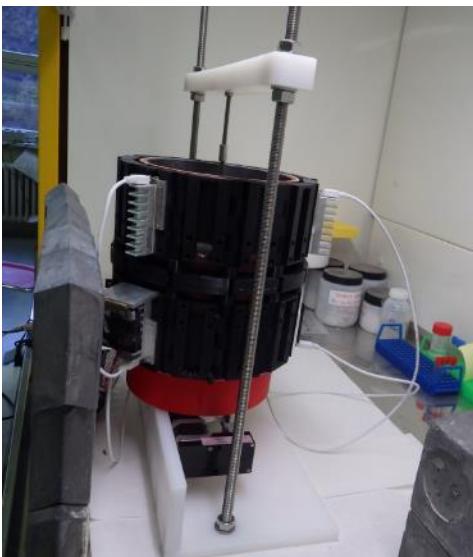
Obr. 14 Vlevo: multikamerový detekční systém na rotačním stolku s uspořádáním detektorů ve dvou patrech, vpravo: fixace fyzikálního modelu během migračního experimentu
