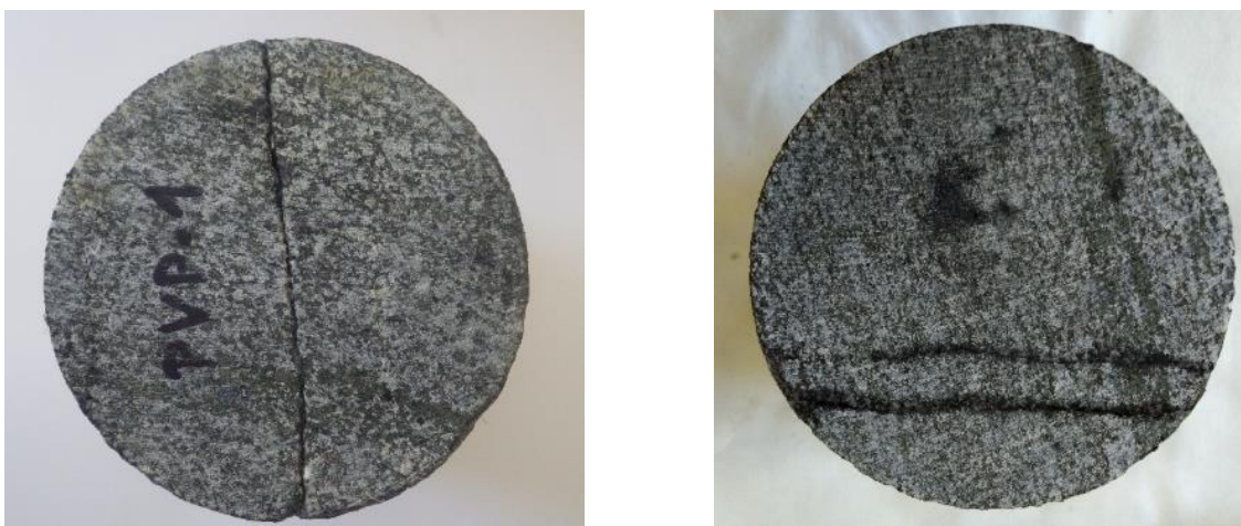
Obr. 2 Podstavy naformátovaného jádra s přirozenou puklinou (ideální rozměry 78 x 90 mm)
