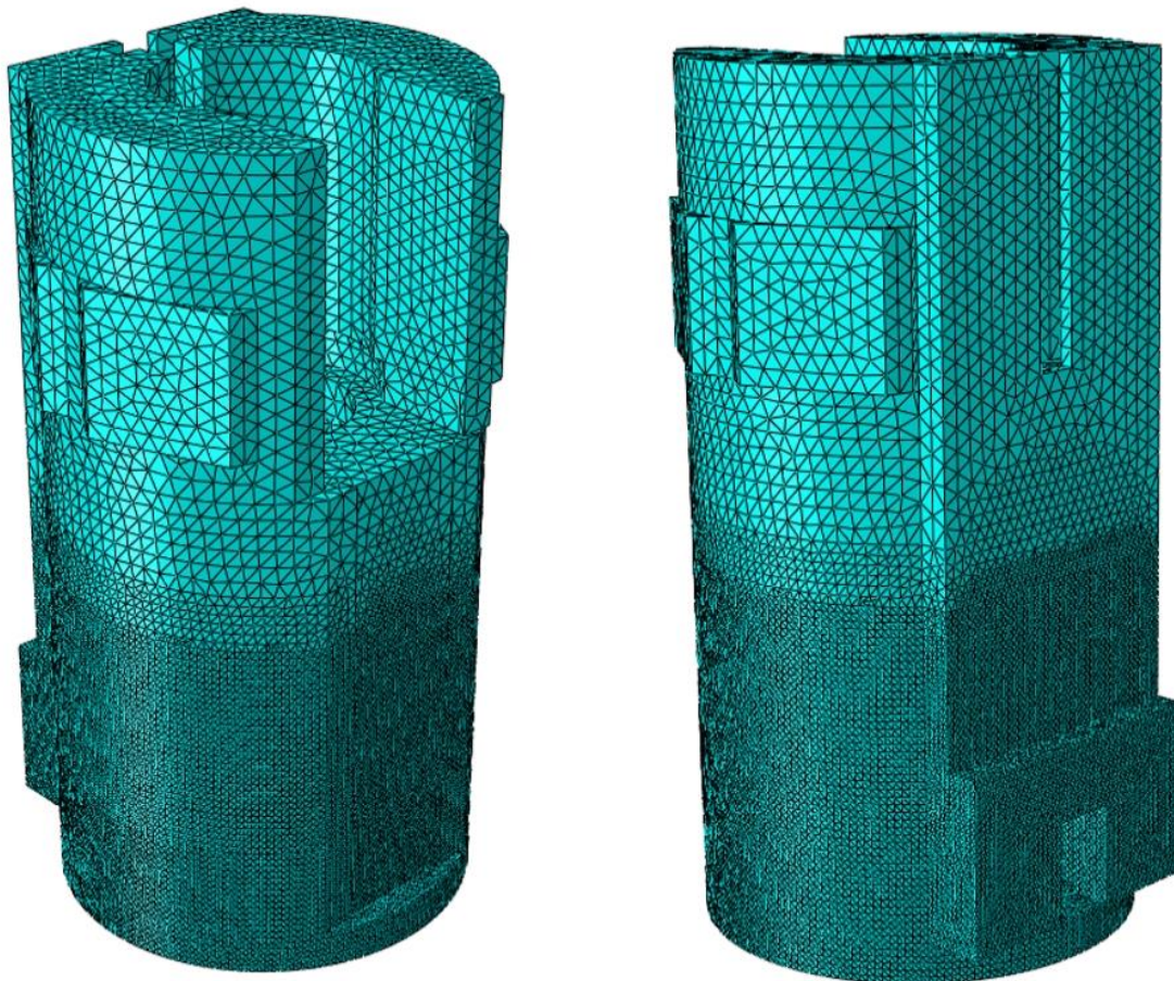
Obrázek 19: Příklad zjemnění sítě konečných prvků na ŠR v JE Temelín
