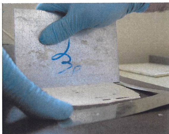
Obr. 4 Rozetření laku stěrkou
