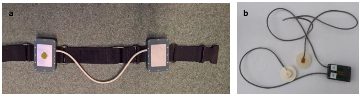
Monitorovací systém FlexiGuard – (a) hlavní monitorovací jednotka na hrudním pásu, (b) 2 senzory kožní teploty připojené k nodu, který obsahuje baterii a vysílač/přijímač dat
