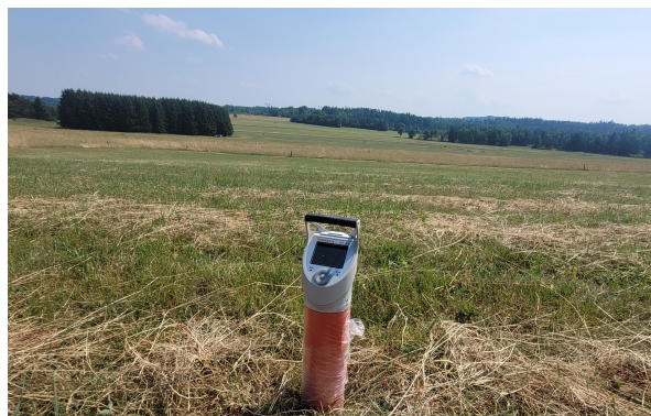
Obrázek 2: Poloha a foto uranové referenční plochy Kunžak s gama spektrometrem GT-40.
