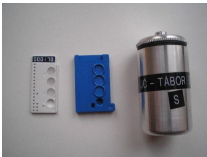
Obr. 2: Součásti TLD (karta s detektory, obal karty, hliníkový kontejner)
