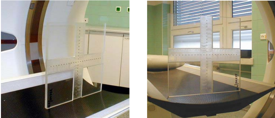
Obr. 24: umístění jednoduché pomůcky při provádění testu souhlasu jednotlivých rovin zobrazení s rovinami zaměřovacího systému
