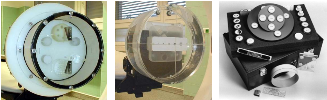
Obr. 15: příklady fantomů obsahující struktury pro stanovení tloušťky tomografické vrstvy
