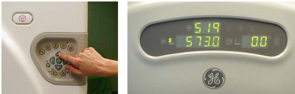
Obr. 5: kontrola funkčnosti ovládacích a indikačních prvků
