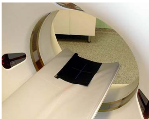
Obr. 17: umístění plastové kazety s filmem na podpěrné desce při měření tloušťky tomografické vrstvy
