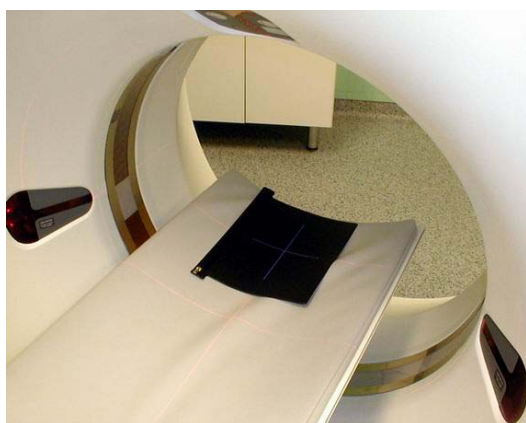
Obr. 27: ukázka výsledku a způsobu vyhodnocení testu přesnosti intervalu mezi axiálními skeny
