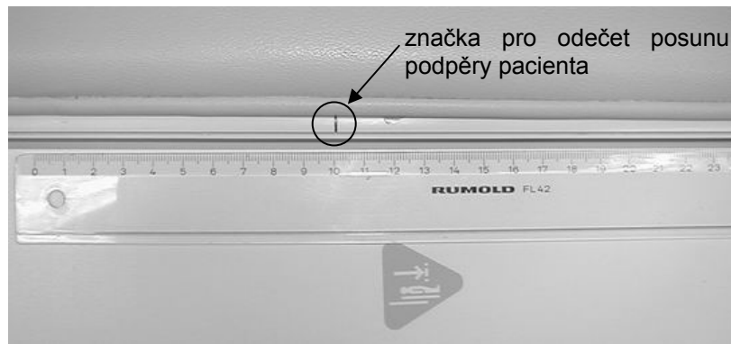
Obr. 20: detailní zobrazení umístění měřítka na pevné části a „pevného bodu“ na pohyblivé podpěře pro pacienta při testu nastavení podpěry pacienta
