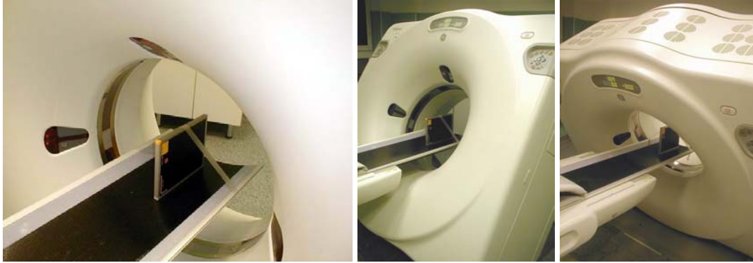
Obr.23: ukázka fixace RTG kazety při testu úhlu sklonu gantry
