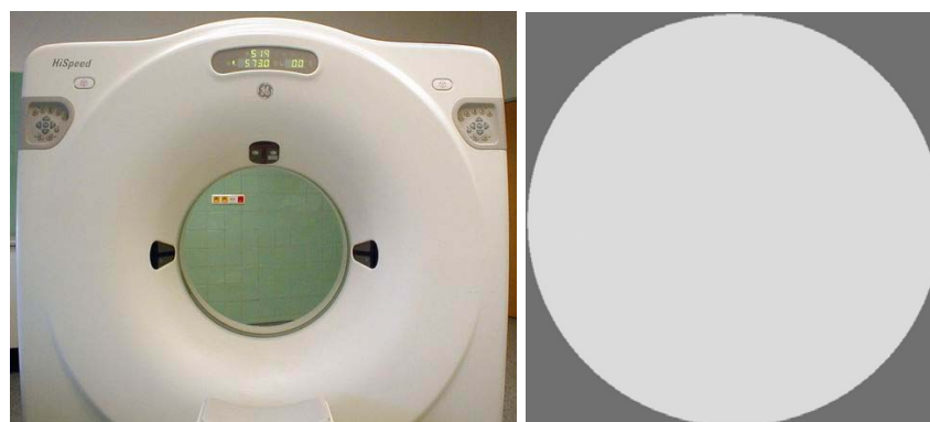
Obr. 8: příklad výsledku testu posouzení výskytu artefaktů (vpravo)
