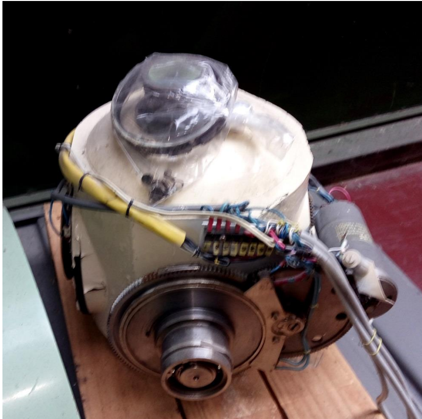
Obr. 5.8 cesioterax – stínění ochuzený uran – váha cca 200kg ( ^{137}\text{Cs} )
