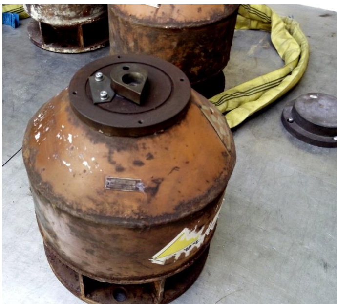
Obr. 3. 23 hladinoměr MDG301 ( ^{60}\text{Co} , ^{137}\text{Cs} )
