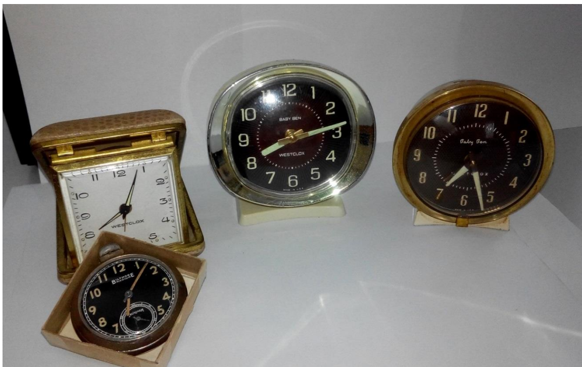
Obr. 6.1 ručičky a ciferníky s luminiscenční barvu obsahující ^{226}\text{Ra} a ^{90}\text{Sr}
