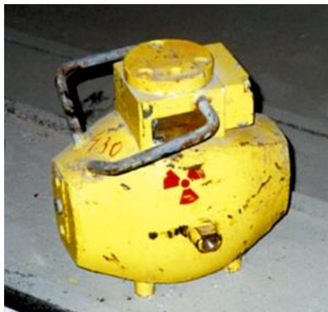
Obr. 3. 10 provozní kontejner PrO-100 (hmotnost 80 kg)
