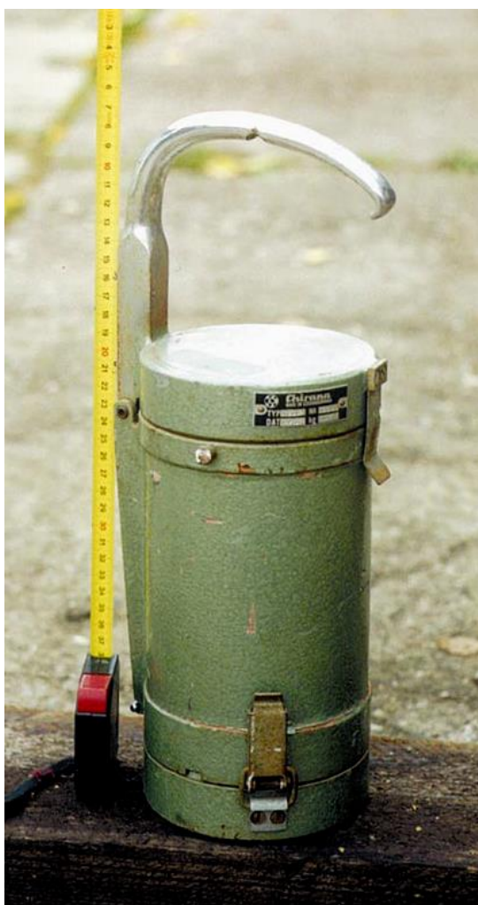
Obr. 5.1 kontejner Chirana M6102. Používaný pro přepravu lékařských ZIZ a to i kapalných. (hmotnost 31 kg)
