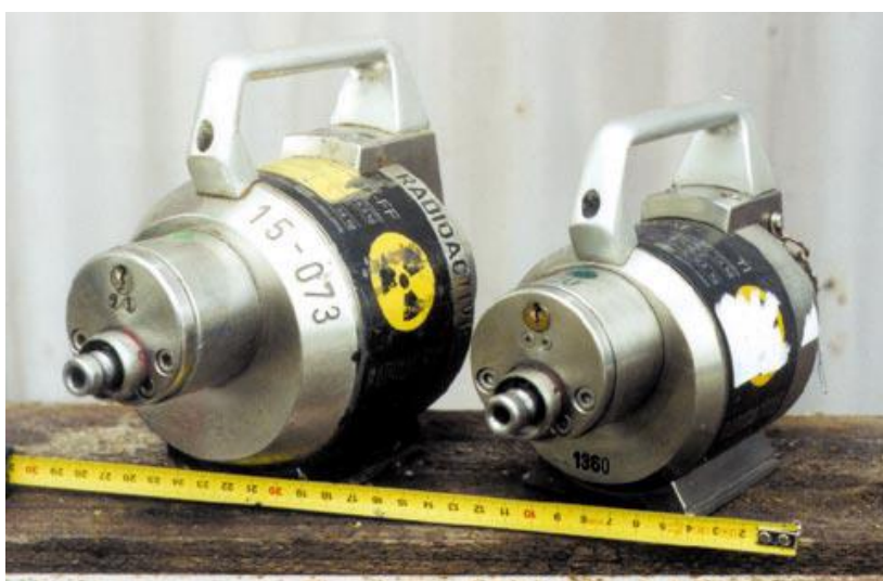
Obr. 4. 4 GAMMAT různé velikosti (rozdílné maximální aktivity)
