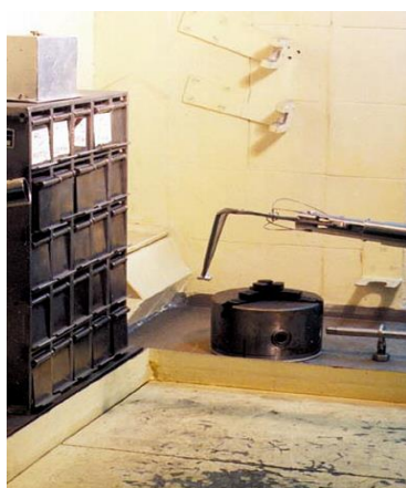
Obr. 1. 11 manipulátory uvnitř polohorké komory – upínací hlava a trezor ZIZ
