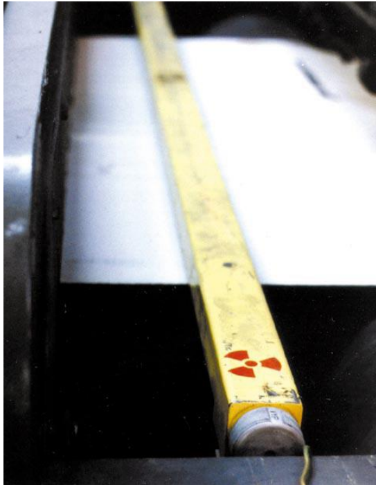
Obr. 3. 1 eliminátor elektrostatického náboje (záření alfa)
