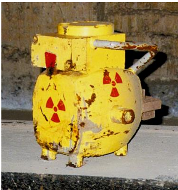
Obr. 3.9 kontejner PrI-20 (hmotnost 48 kg)
