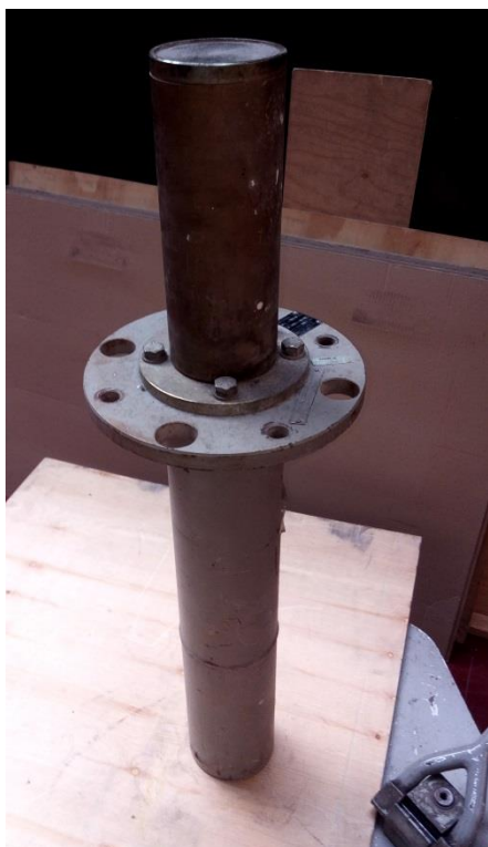
Obr. 3. 21 hladinoměr Berthold LB367 ( ^{137}\text{Cs} )
