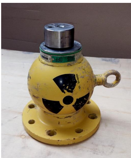
Obr. 3. 15 Hladinoměr / hustoměr ( ^{60}\text{Co} , ^{137}\text{Cs} )
