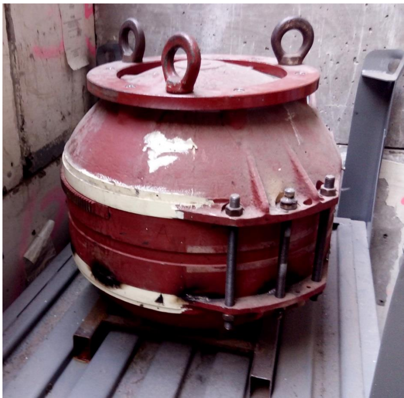
Obr. 5.9 chisostat- stínění olovo/ochuzený uran ( ^{60}\text{Co} )
