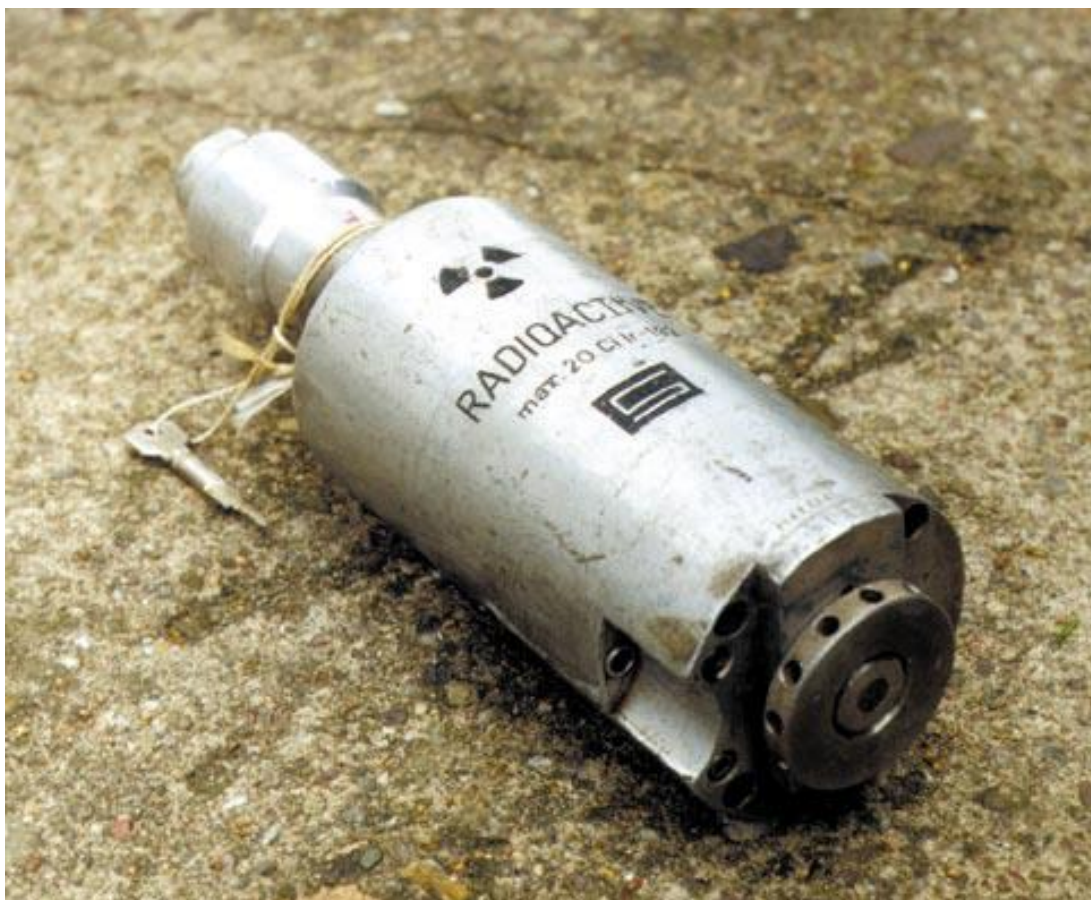
Obr. 4. 9 defektoskopické zařízení typu „Molch“
