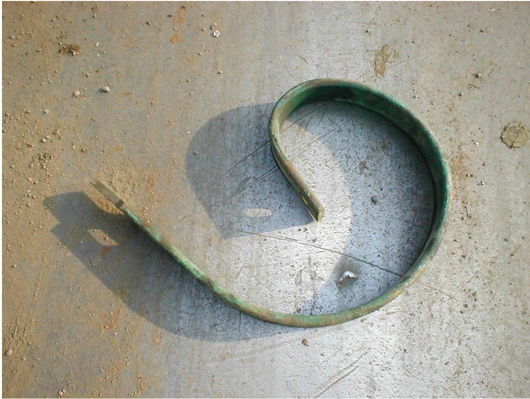
Obr. 6.7 Pružiny držáku radliček kultivátoru, vyrobený z tavby kontaminované ^{60}\text{Co}
