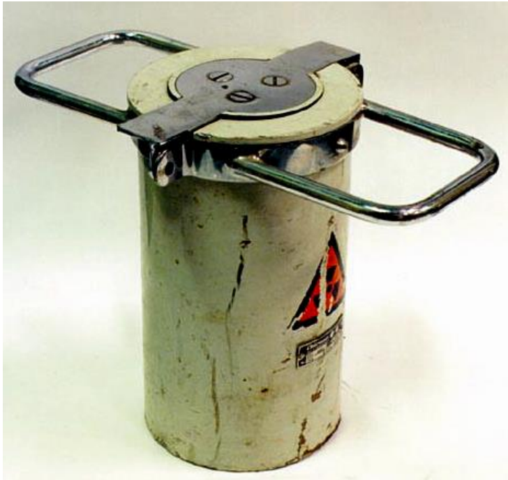
Obr. 5.3 Kontejner, typ Chirana 392. výška 26 cm, průměr 14 cm. (hmotnost 42 kg)
