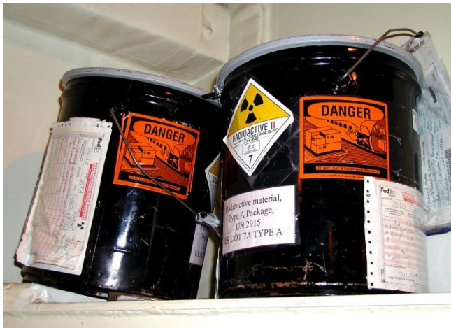
Obr. 6.1 přepravní obal, většinou obsahuje samostatné stínění samotný je velmi lehký – TYP A
