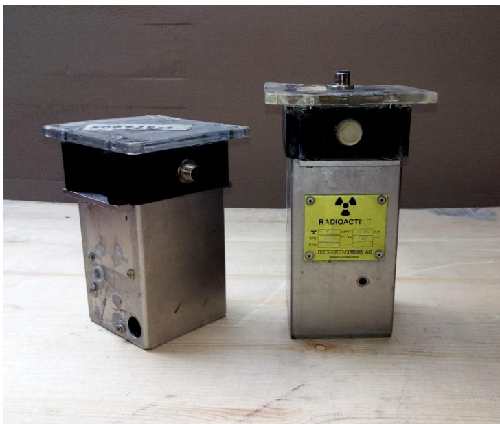
Obr. 3. 22 Hladinoměr Checkmat ( ^{241}\text{Am} )
