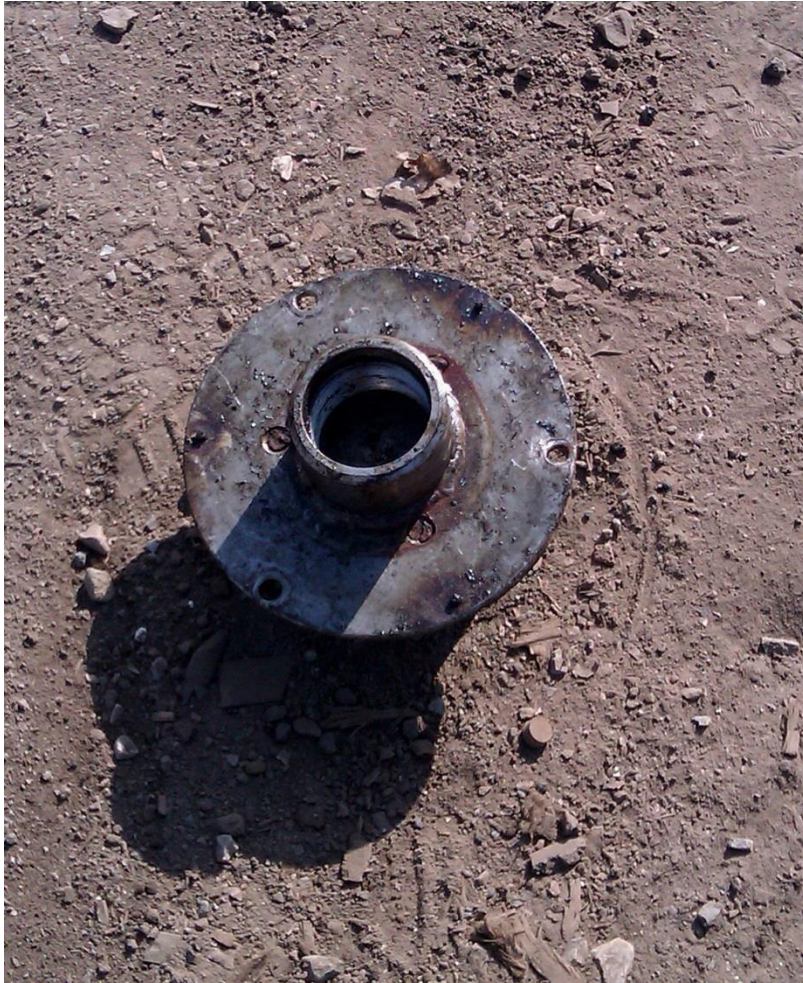
Obr. 6.9 ZIZ instalovaný na hromosvod – radionuklid EU
