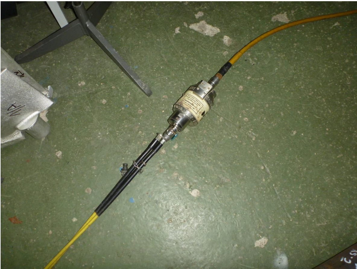
Obr. 4. 5 pracovní zapojení defektoskopické soupravy ( GAMMATAT)
