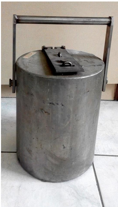
Obr. 6.5 stínění používané pro neutronové ZIZ – překvapivě lehké (hmotnost 23 kg)
