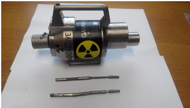
Obr. 4. 1 v ČR nejrozšířenější typ defektoskopického krytu - GAMMAT
