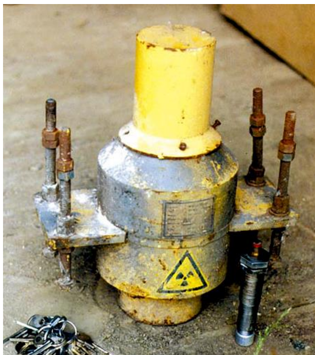
Obr. 3. 11 Provozní kontejner popeloměru, ZIZ zakrytý (hmotnost 44 kg)
