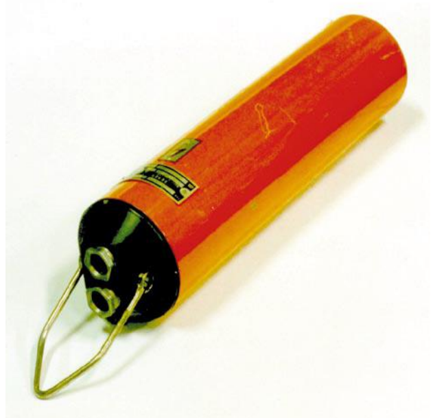
Obr. 3. 8 Sonda MKD 103 k indikátoru úrovně hladiny a polohy. Sonda sama ZIZ neobsahuje
