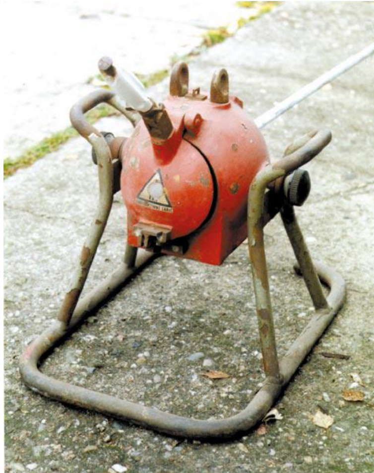
Obr. 4. 11 Defektoskopický přístroj z r. 1962 typu OK – váha cca 55kg
