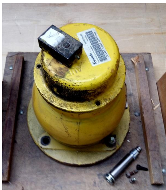
Obr. 3. 24 hladinoměr Robotron ( ^{60}\text{Co} , ^{137}\text{Cs} )
