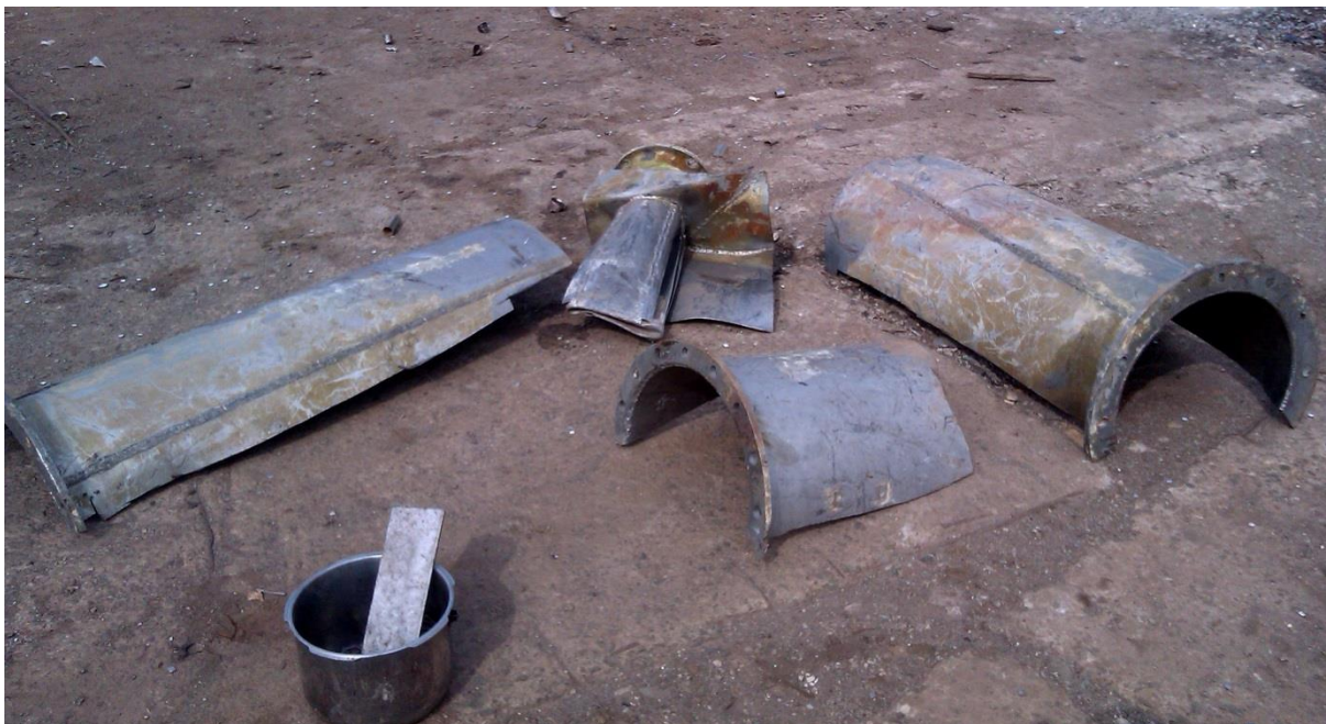
Obr. 6.3 předměty s nánosem barvy s ^{226}\text{Ra}
