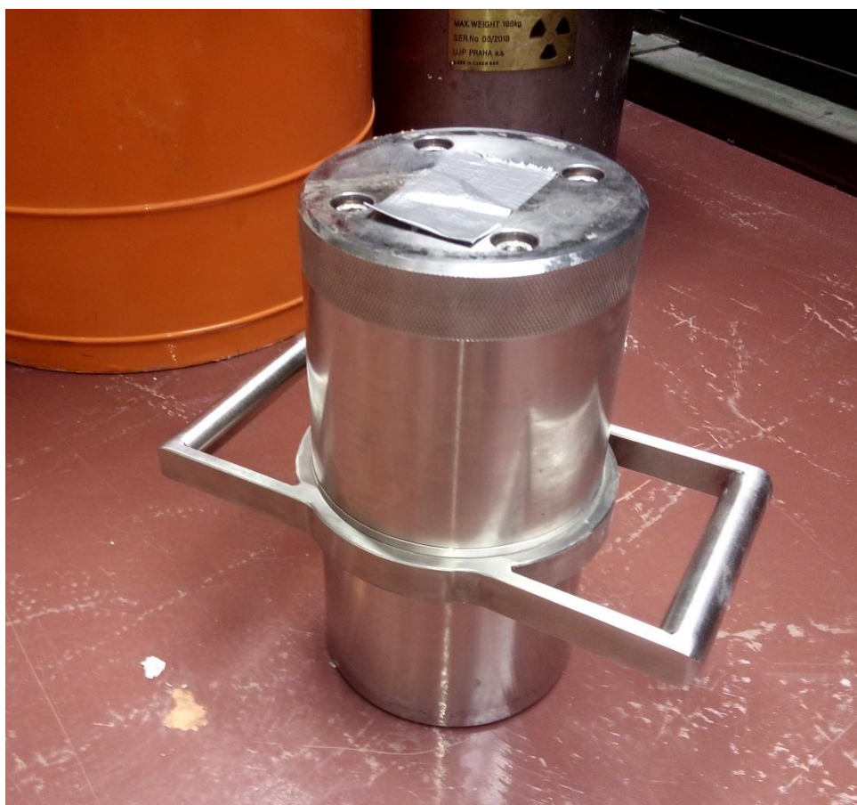
Obr. 6.8 UKI4 – stínění uran – použití pro transport nosičů URZ ( ^{192}\text{Ir} , ^{75}\text{Se} )
