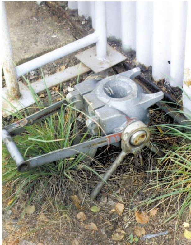
Obr. 4. 15 defektoskopický přepravní kryt, hmotnost cca 55kg
