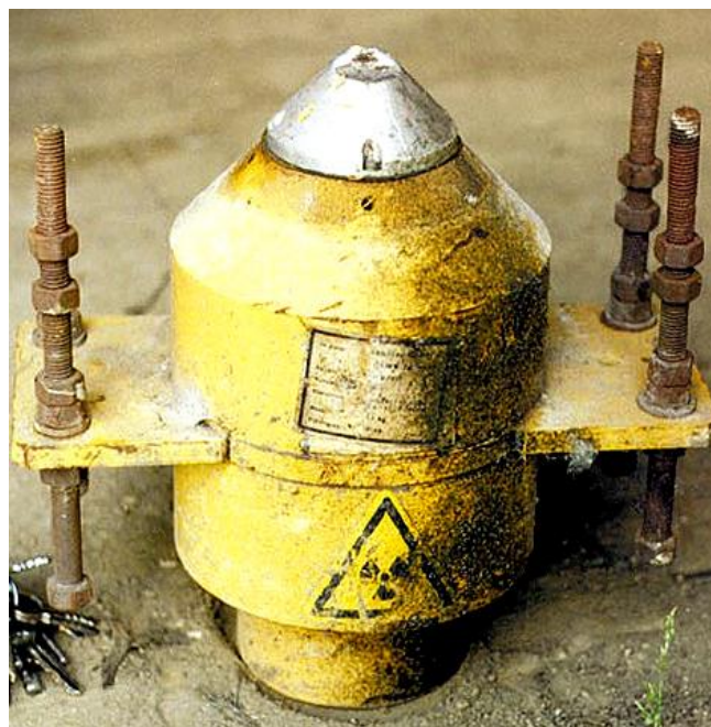
Obr. 3. 12 Provozní kontejner popeloměru, ZIZ odkrytý
