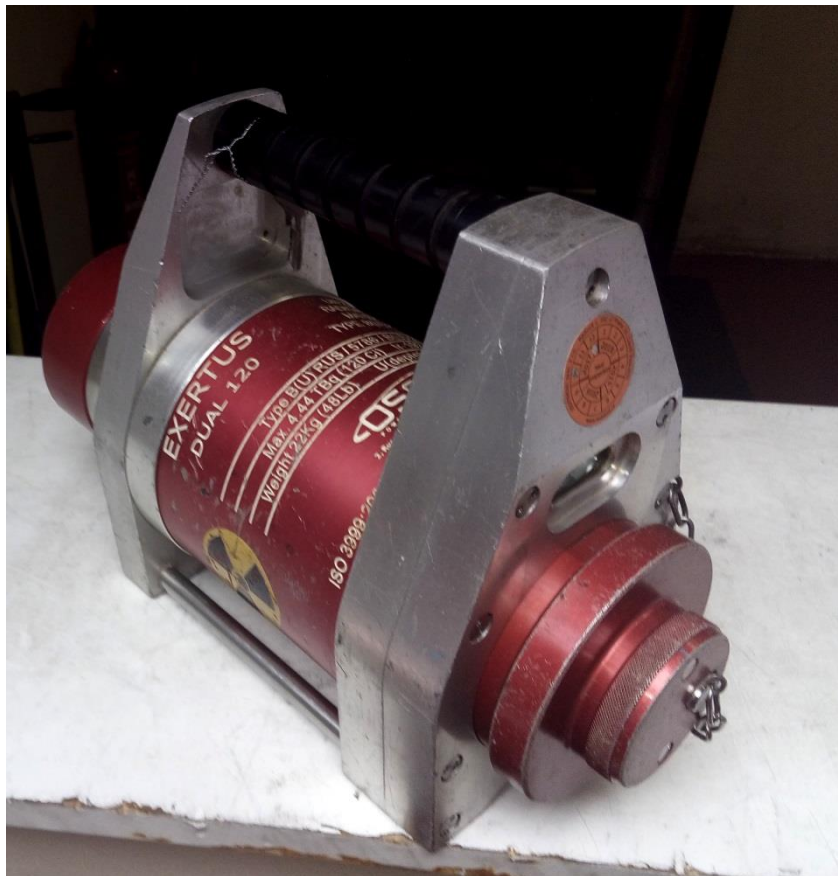
Obr. 4.23 EXERTUS DUAL - stínění uran ( ^{192}\text{Ir} , ^{75}\text{Se} )
