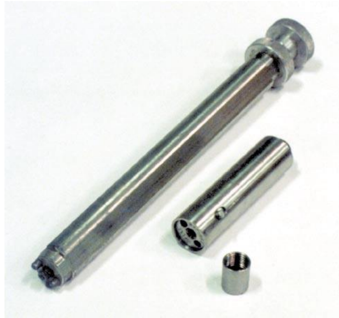
Obr. 1. 18 manipulátor používaný k manipulaci se ZIZ v krytech
