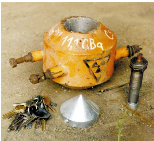
Obr. 3. 13 Provozní kontejner popeloměru (hmotnost 25 kg)
