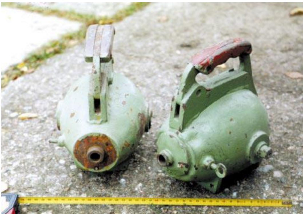
Obr. 4. 13 defektoskopický kryt používaný kolem roku 1950, váha cca 22kg
