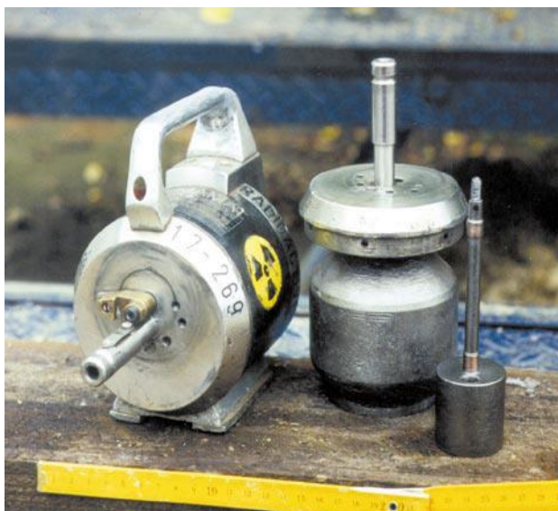
Obr. 4. 6 částečně rozebrané zařízení GAMMATAT
