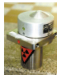
Popeloměr (obsahuje dva Z12 – ^{241}\text{Am} , ^{137}\text{Cs} )
