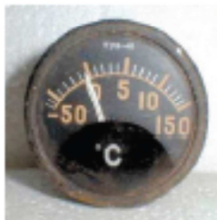
Stupnice - luminiscentní barva obsahující ^{226}\text{Ra} a ^{90}\text{Sr}
