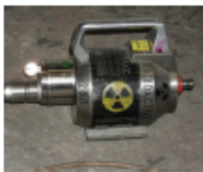
Defektoskopický pracovní kryt typ. GAMMATAT ( ^{137}\text{Cs} , ^{75}\text{Se} )
