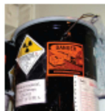
Kontejner pro různé RA látky ( ^{137}\text{Cs} , ^{60}\text{Co} ) POZOR – prázdný je velmi lehký
