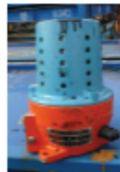
Průmyslový typ kouřového detektoru ( ^{241}\text{Am} )
