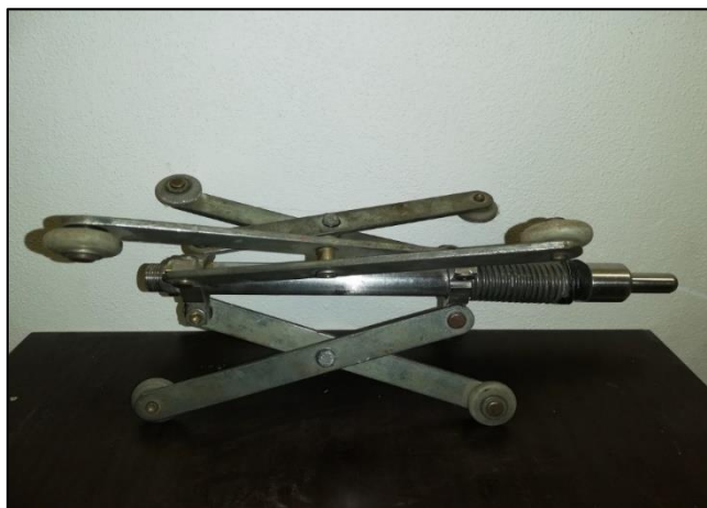
Obrázek č. 15 – „Pavouk“ pro prozařování svarů ze středu potrubí.
