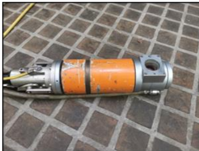
Obr. č. 4 Detail rentgenky typu Isovolt 160/M1.
