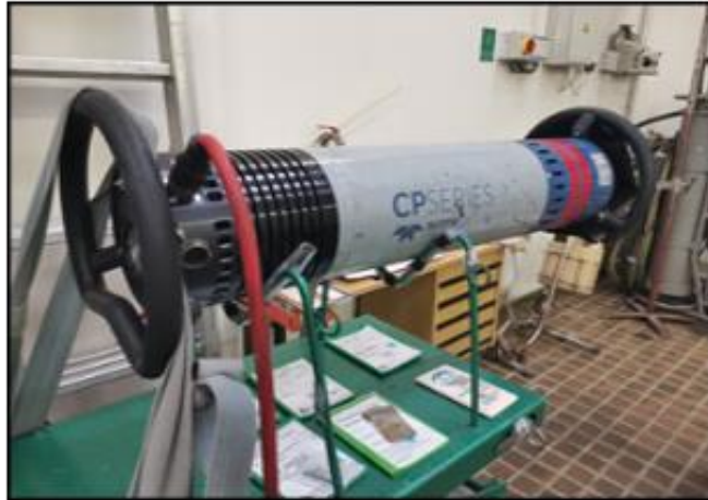
Obr. č. 5 Panoramatický RTG přístroj SITE X CP300C 300 kV, 10 mA.
