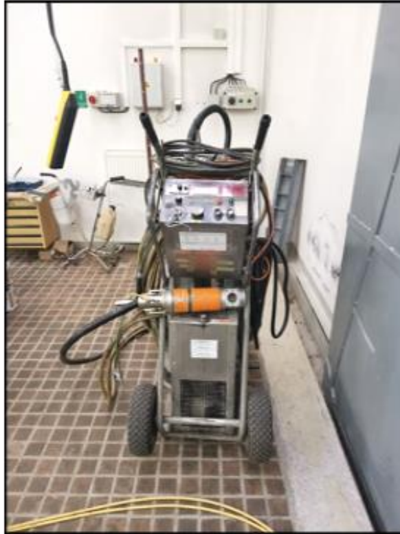
Obr. č. 3 Mobilní RTG přístroj 160 kV, 10 mA.
