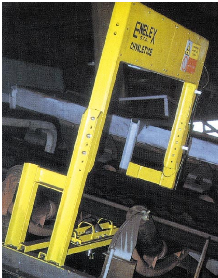
Obr. 3.16 Gamapopeloměr GE 1100.S, celkový pohled na zařízení. Záříč se nachází pod pásem, mezi dvěma žlutými „uchy“ je vidět špička krytu. Výrobek firmy Enelex Chvaletice, ČR. Firemní materiál firmy Enelex s.r.o. Chvaletice, ČR. Viz též obr. 3.18 a 3.19
