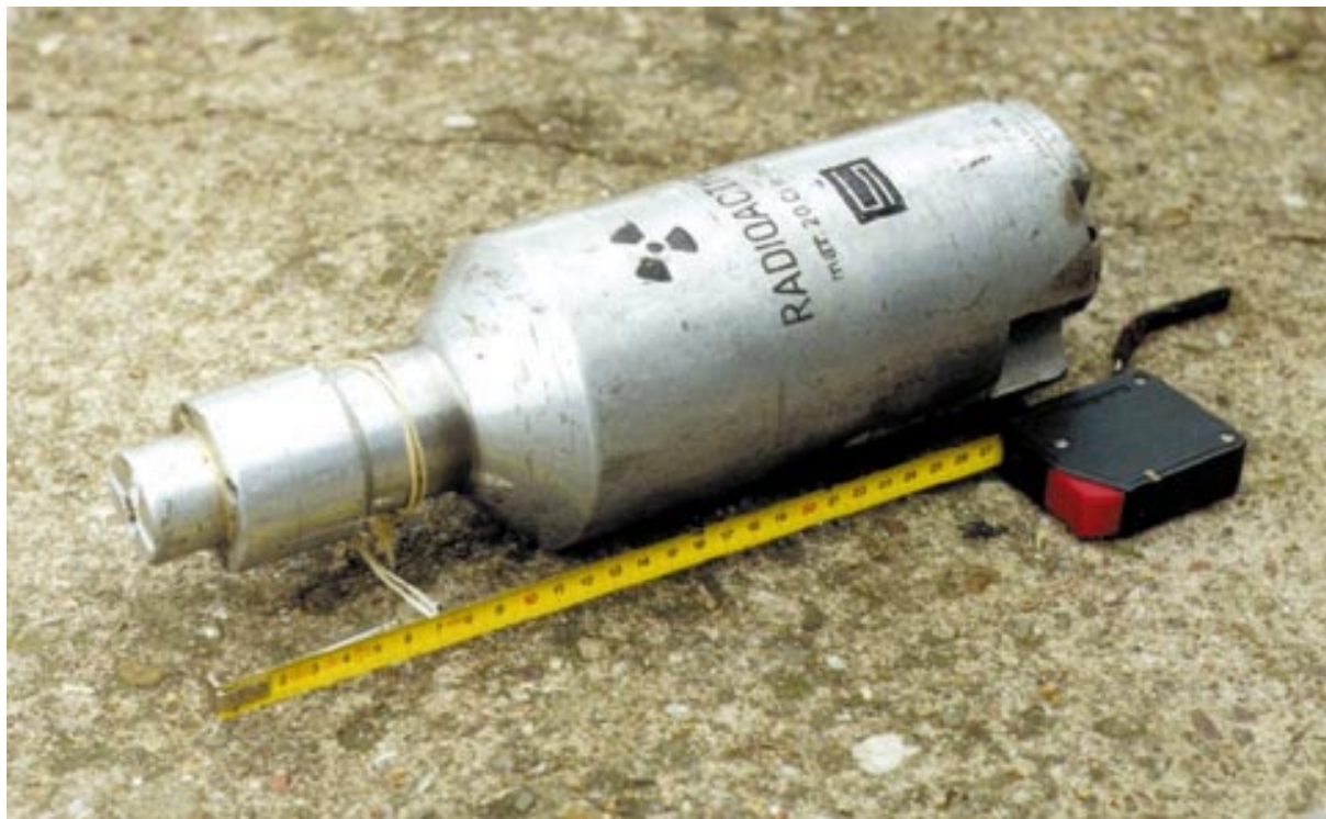
Obr. 4.10 Defektoskop M6 "Molch" ("malý Mlok") pro kontrolu svarů plynovodů apod. Při práci je umístěn na dálkově ovládaném vozíku (viz obr. 4.12), který zajišťuje pohyb v potrubí. Tento defektoskop obsahuje zářič ^{192}\text{Ir} max. 740 GBq, stínění má uranové
