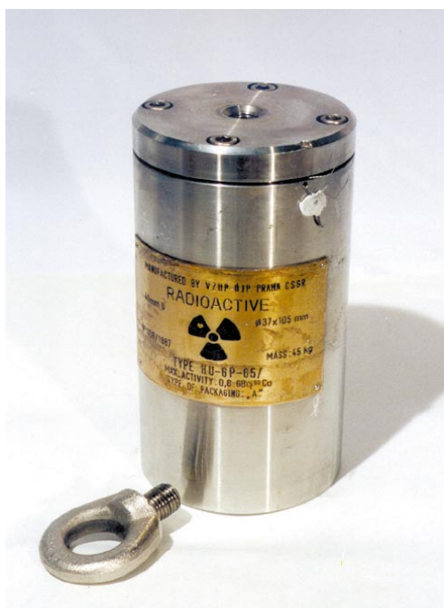
Obr. 6.3 Přepravní kontejner HU-GP-65 novější výroby s demontovaným okem
