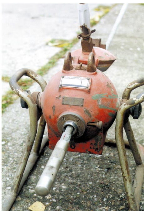
Obr. 4.18 Defektoskopický přístroj OK 0.5 - pohled zezadu na pracovní polohu s vysunutým zářičem
