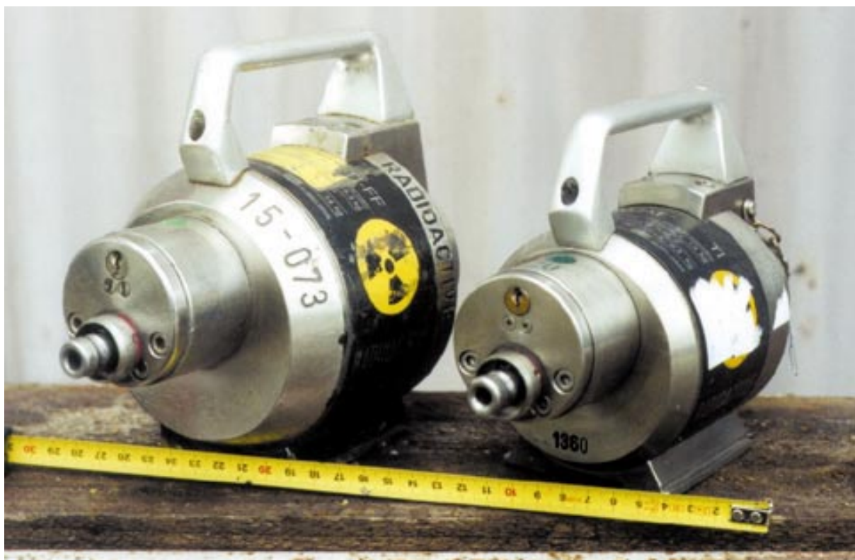
Obr. 4.13 Defektoskopy používané v současné době: vlevo Gammamat TI-FF (18,5 kg, z toho 14 kg ochuzeného uranu, zářič max. 4,884 TBq ^{192}\text{Ir} ), vpravo Gammamat TI (13 kg, uranu 9,4 kg, zářič max. 1,5 TBq ^{192}\text{Ir} ). Výrobce VKTA Rossendorf, Německo
