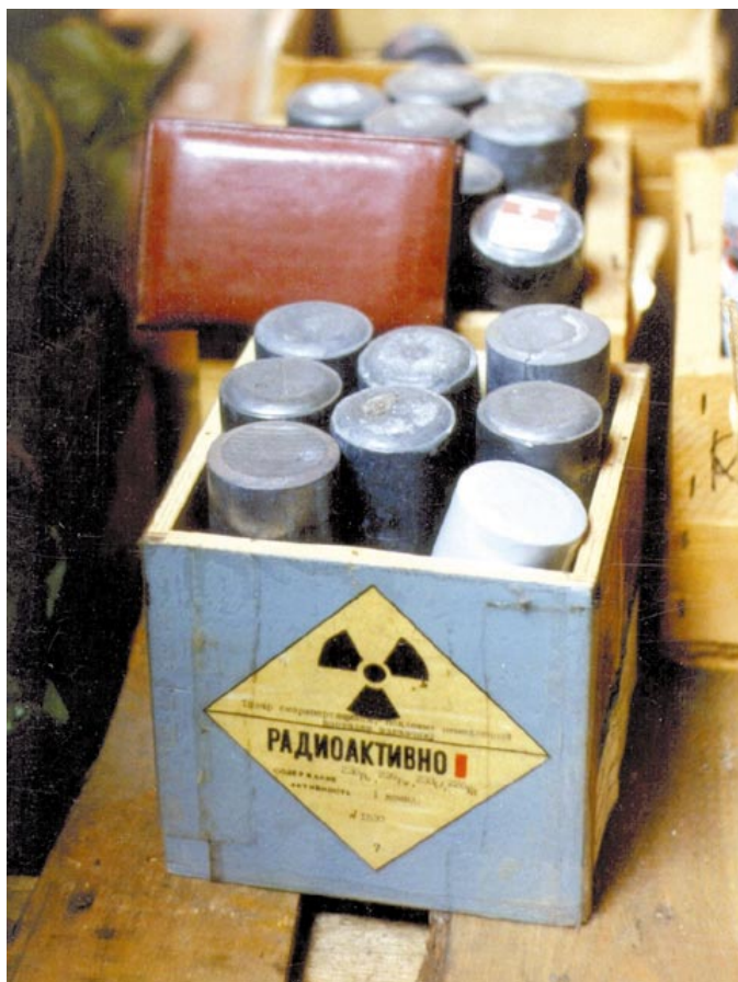
Obr. 6.48 Vnější olověné kontejnerky pro zářiče o aktivitě do stovek kBq
