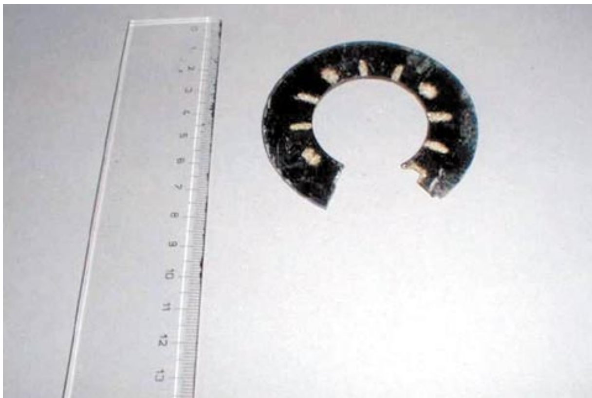
Obr. 7.4 Matrice hodinových ciferníků s nanesenou luminiscenční barvou obsahující ^{226}\text{Ra} a ^{90}\text{Sr} nalezené v komunálním odpadu. Foto SÚRO
