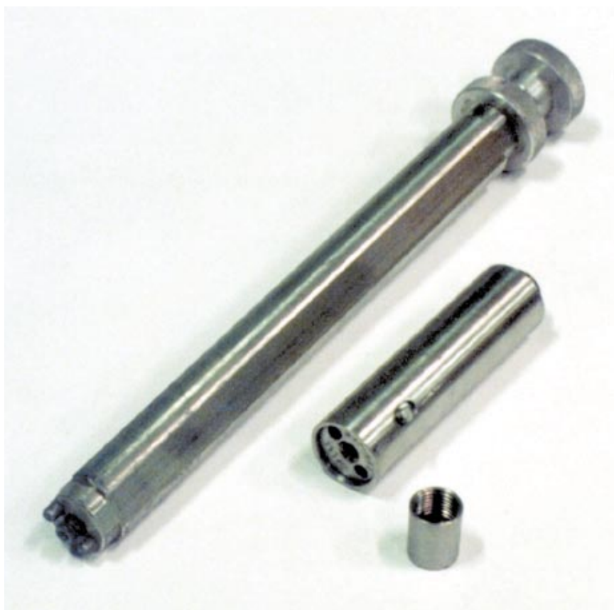
Obr. 3.4 Manipulátor a držák zářiče pro kryty HHT-52
