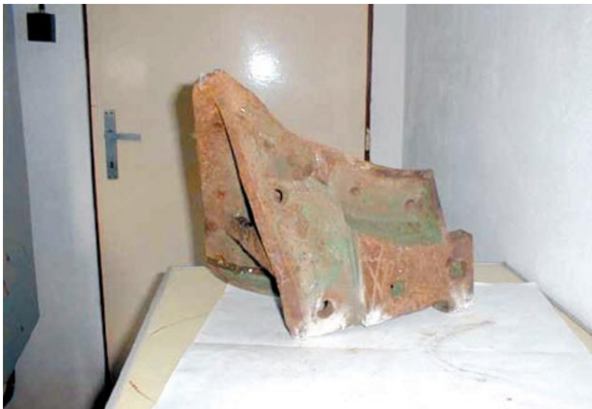
Obr. 7.12 Hutnické výrobky kontaminované ^{60}\text{Co} z náhodně roztavených zdrojů. Aktivity v rozmezí desítek kBq/kg až desítek MBq/kg, dávkové příkony v kontaktu 1-100 xGy/h. Radlice. Foto SÚRO
