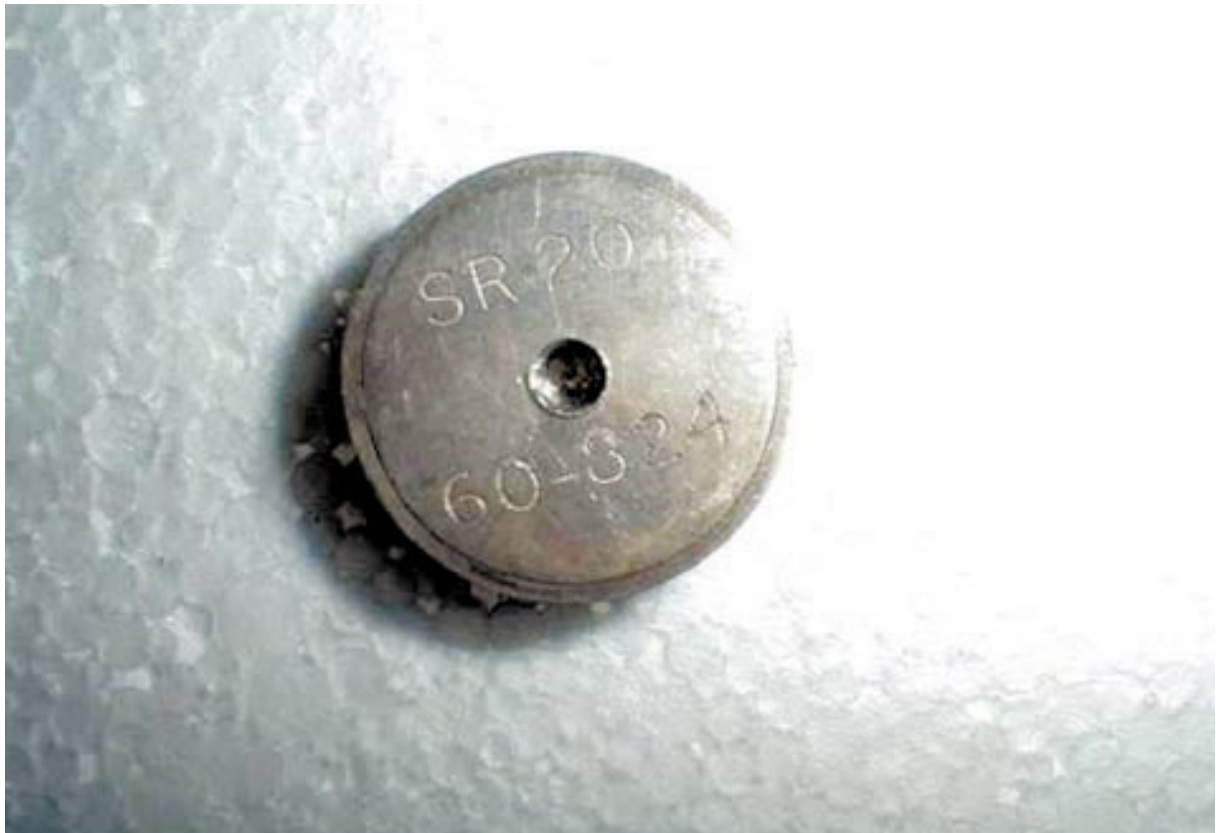
Obr. 7.15 Zdroj ^{90}\text{Sr} z tloušťkoměru nalezený v kovovém šrotu. Původní aktivita 740 MBq, dávkový příkon v 1m cca 1 xGy/h. Foto SÚRO
