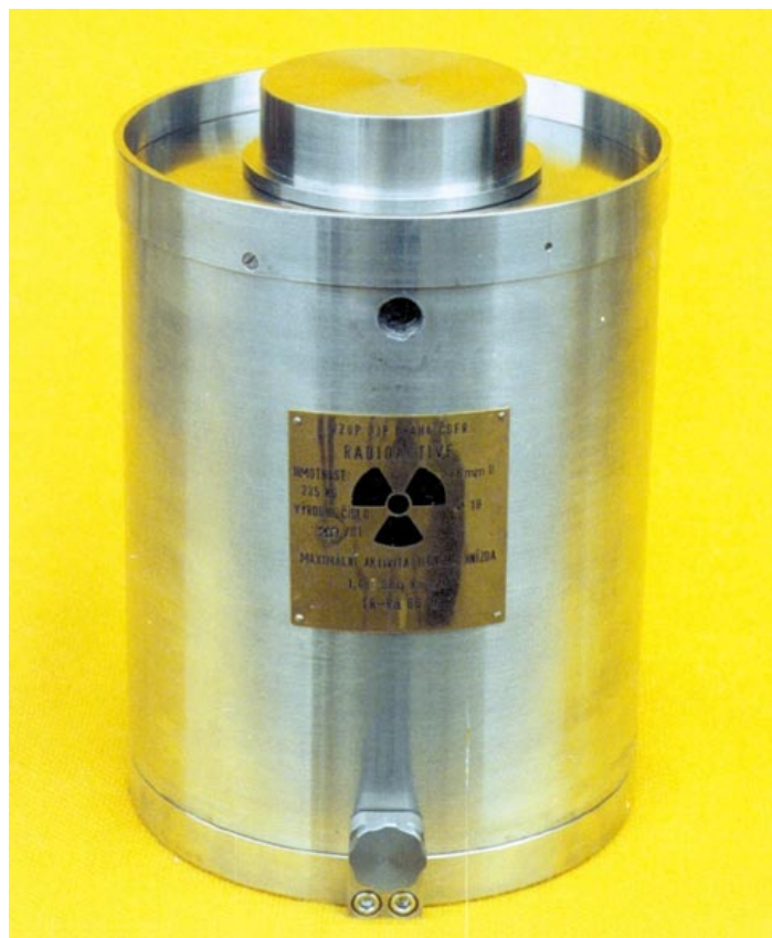
Obr. 5.2 Totéž bez nástavce, hmotnost 235 kg. Foto ŠKODA - ÚJP, Praha, a.s.
