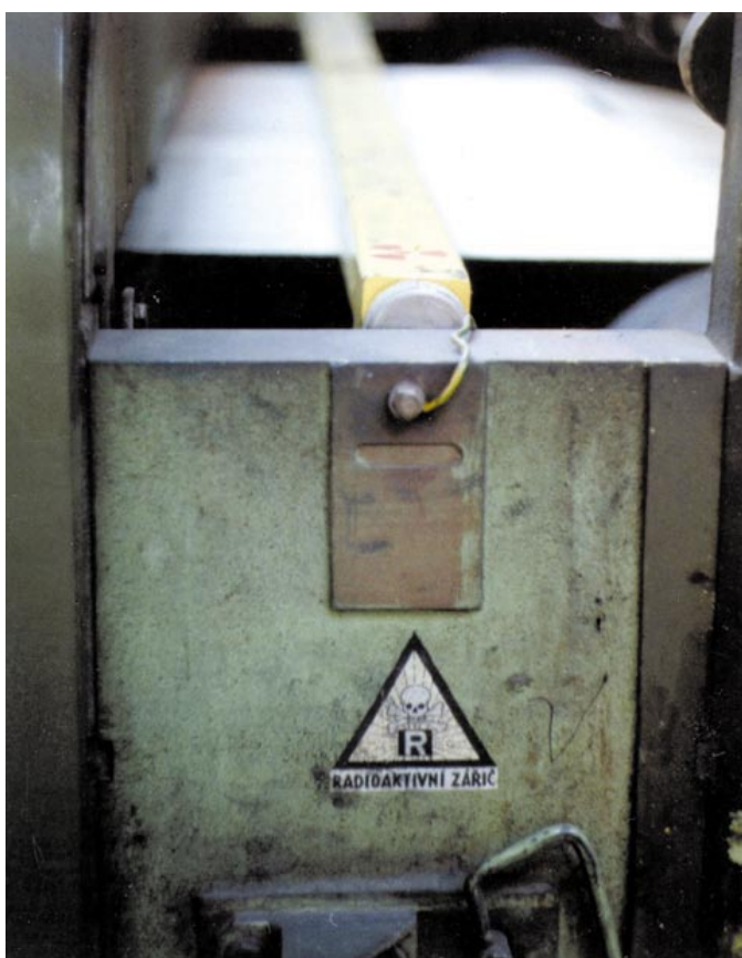
Obr. 1.3 Eliminátor elektrostatického náboje (žlutá tyč nahoře) na potěrací stroji pro pogumování tkanin. Silný alfa zářením se s povrchu tkaniny odstraní elektrostatický náboj a sníží se nebezpečí výbuchu par používaných rozpouštědel
