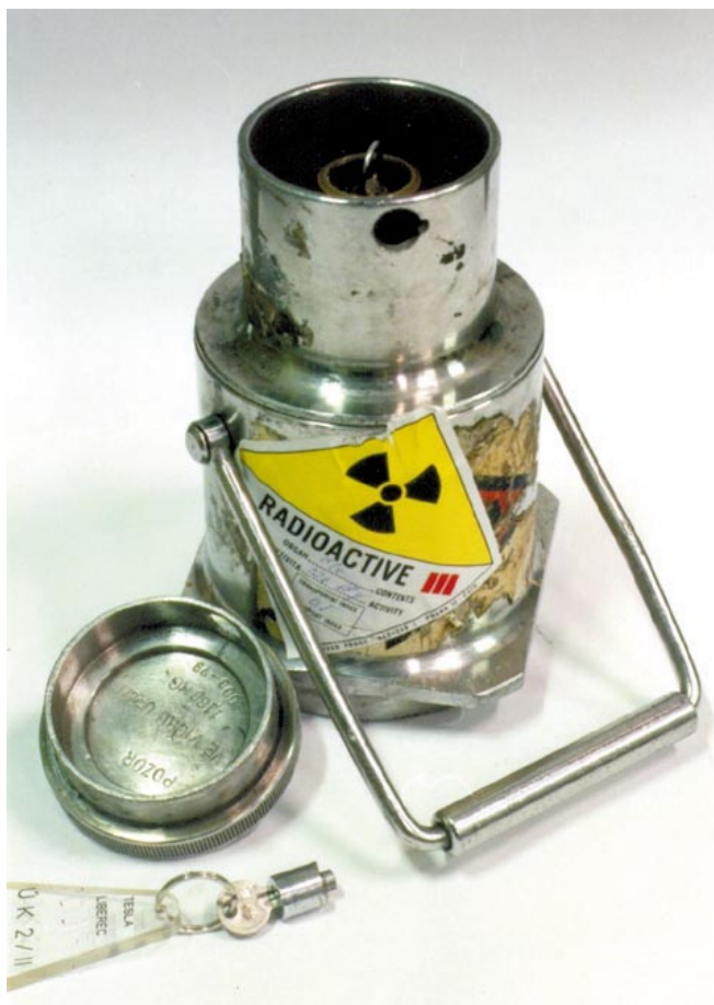
Obr. 6.13 Přepravní kontejner UK 2/II třídy B, výška 25,5 cm, průměr velkého válce 14 cm, hmotnost 25 kg. Byl vyroben ve velkém počtu kusů a určen k přepravě max. 81 GBq ^{137}\text{Cs} . Velmi podobný byl též typ UK 2 a UK 2/I
