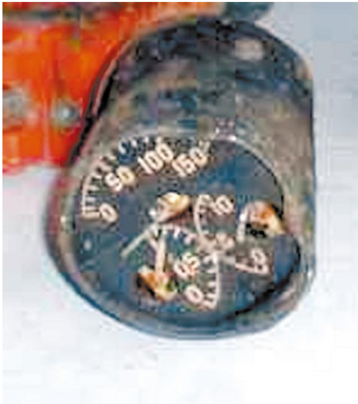
Obr. 7.7 Další vojenský přístroj s nanesenou luminiscenční barvou obsahující ^{226}\text{Ra} . Foto SÚRO
