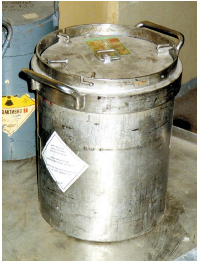
Obr. 6.32 Přepravní obal na kontejner třídy B, typ BG-22, německé výroby. Rozměry 30x40 cm, hmotnost vč. kontejneru 110 kg. Používá se na zářiče o vysoké aktivitě
