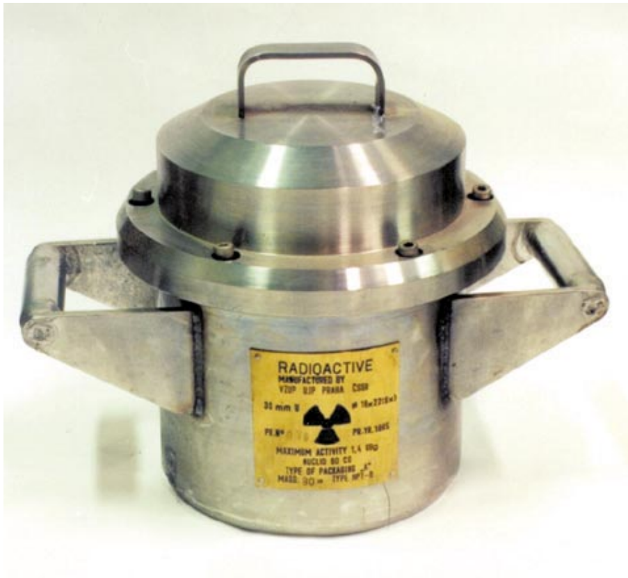
Obr. 6.28 Přepravní kontejner HPT-6 třídy A, uranové stínění, průměr 25 cm, výška 27 cm, hmotnost 80 kg. Určen k přepravě max. 1,4 GBq ^{60}\text{Co} , ale používán i pro ^{137}\text{Cs} a jiné nuklidy
