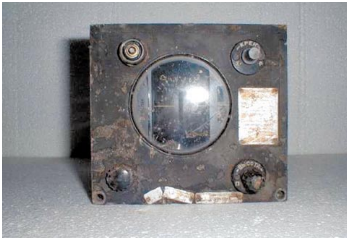
Obr. 7.6 Jiný vojenský přístroj s nanesenou luminiscenční barvou obsahující ^{226}\text{Ra} . Foto SÚRO
