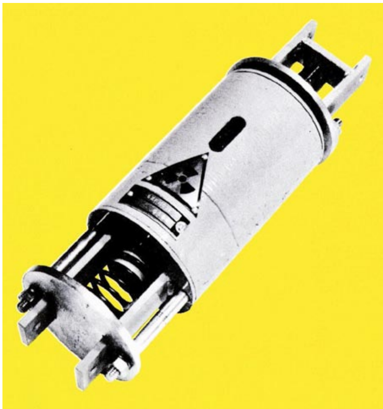
Obr. 3.5 MDG 201 - kryt zářiče určený k montáži do ochranných trubek. Zářič je ^{60}\text{Co} o aktivitě do 700 MBq (ale s přídavným stíněním i silnější). Vyráběla Tesla Liberec, ČSSR. Firemní materiál býv. Tesly Liberec
