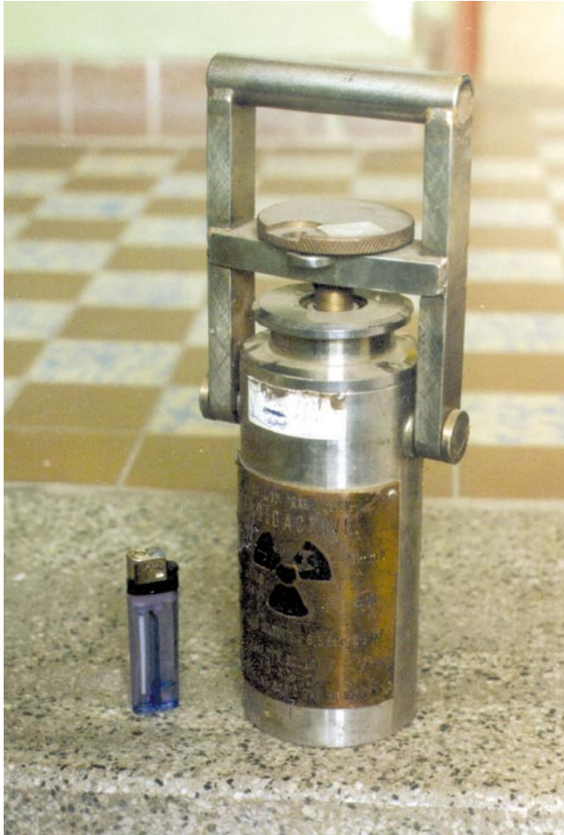
Obr. 6.9 Starší přepravní kontejner třídy A, typ TO-ACs-21. Uranové stínění, celková výška 30 cm, hmotnost 15 kg, max. 5x0,7 GBq 137 Cs
