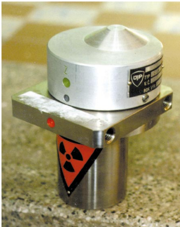
Obr. 3.18 Provozní kontejner CsAm 16/II, používaný v gamapopeloměru GE 1100 S. Tyto přístroje obsahují 2 rozdílné zářiče: zdroj záření alfa a záření gama, v tomto případě 12 GBq ^{241}\text{Am} a 0,62 GBq ^{137}\text{Cs} . Stínění je z ochuzeného uranu. Výška cca 16 cm. Výrobek ŠKODA - ÚJP, Praha, a.s.
