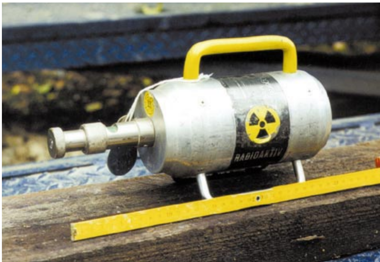
Obr. 4.12 Komandogerät - ovladač pohybu "mloků" v potrubí. Zářič ^{137}\text{Cs} , max. 13 GBq. Uranové stínění, hmotnost přístroje 6,5 kg
