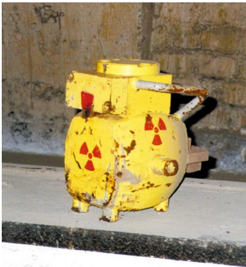
Obr. 3.33 Polský provozní kontejner PrI-20 s Pb stíněním. Hmotnost 48 kg
