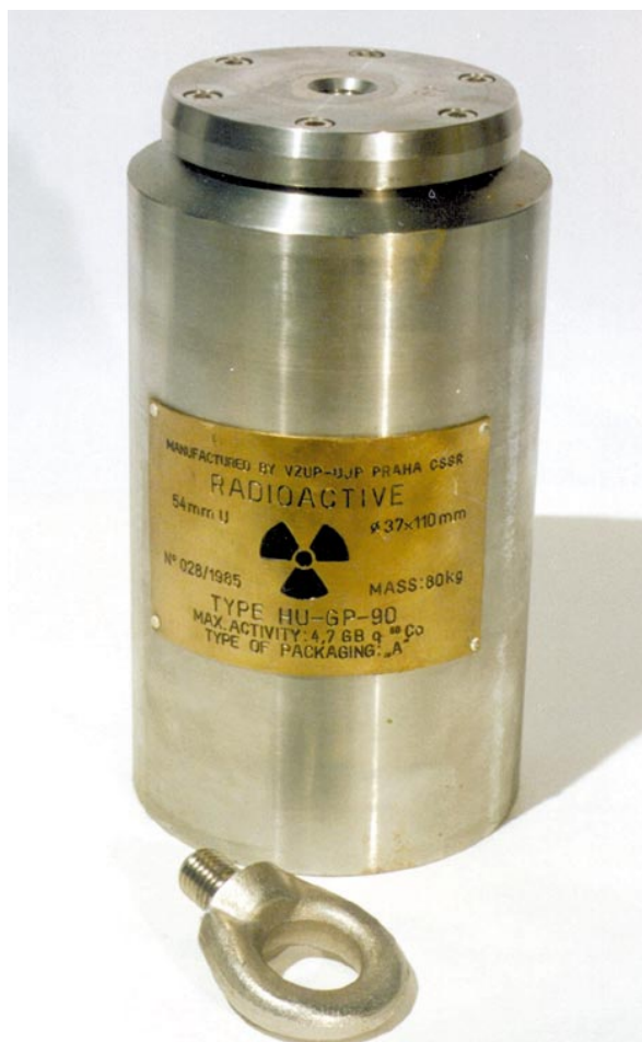
Obr. 6.5 Přepravní kontejner HU-GP-90. Je největším z typové řady HU-GP. Rozměry 15,6x35 cm, hmotnost 80 kg. Kontejnery mohou obsahovat různé zářiče, tento až do jednotek GBq (pro ^{60}\text{Co} ). Foto ŠKODA - ÚJP Praha, a.s.
