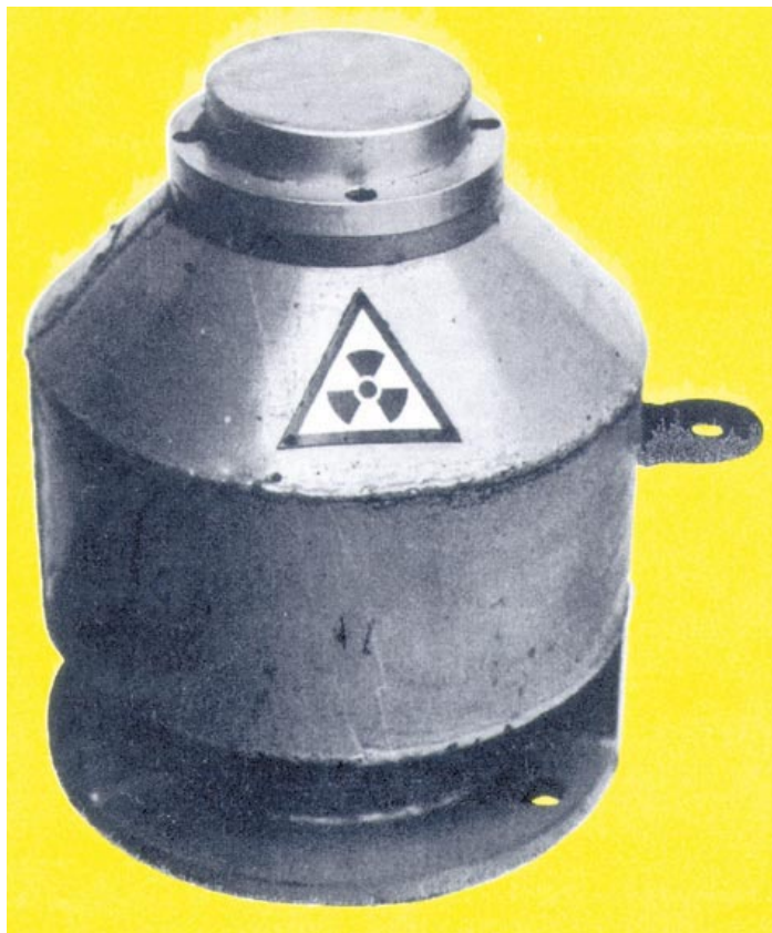
Obr. 3.1 MDG 301 - kryt zářiče k indikátoru poloh a hladin. Použití v zásobnících, nádržích, silech apod. Může obsahovat buď ^{60}\text{Co} o aktivitě do 23,3 GBq nebo ^{137}\text{Cs} do 116,5 GBq. Firemní materiál býv. Tesly Liberec
