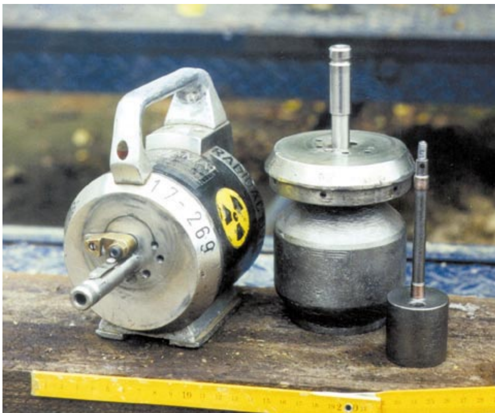
Obr. 4.14 Rozebraný Gammamat TIF. Vpravo jsou odděleny oba díly stínění z ochuzeného uranu. Přístroj může obsahovat max. 3,75 TBq 192Ir
