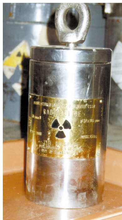
Obr. 6.2 Přepravní kontejner HU-GP-65 novějšího provedení - oko k uchycení nahoře
