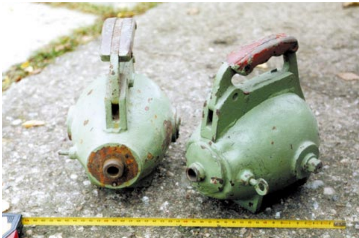
Obr. 4.19 Přepravní i pracovní kontejnery na defektoskopické zářiče ze cca 50.-60. let 20. stol. Používalo se tehdy pouze ^{137}\text{Cs} , max. aktivita přibližně 37 GBq. V ose "vajička" je kanál, ze kterého se pomocí tyče vysouval zářič do pracovní polohy. Olověné stínění, ocelový plášť. Hmotnost přibližně 22 kg
