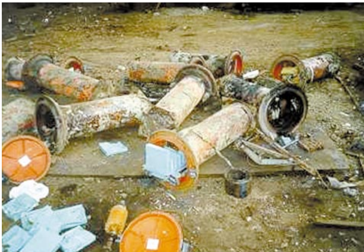
Obr. 7.10 Kabelové zesilovače osazené bleskojistkami obsahujícími ^{226}\text{Ra} . Pohled na celé zařízení. Foto SÚRO
