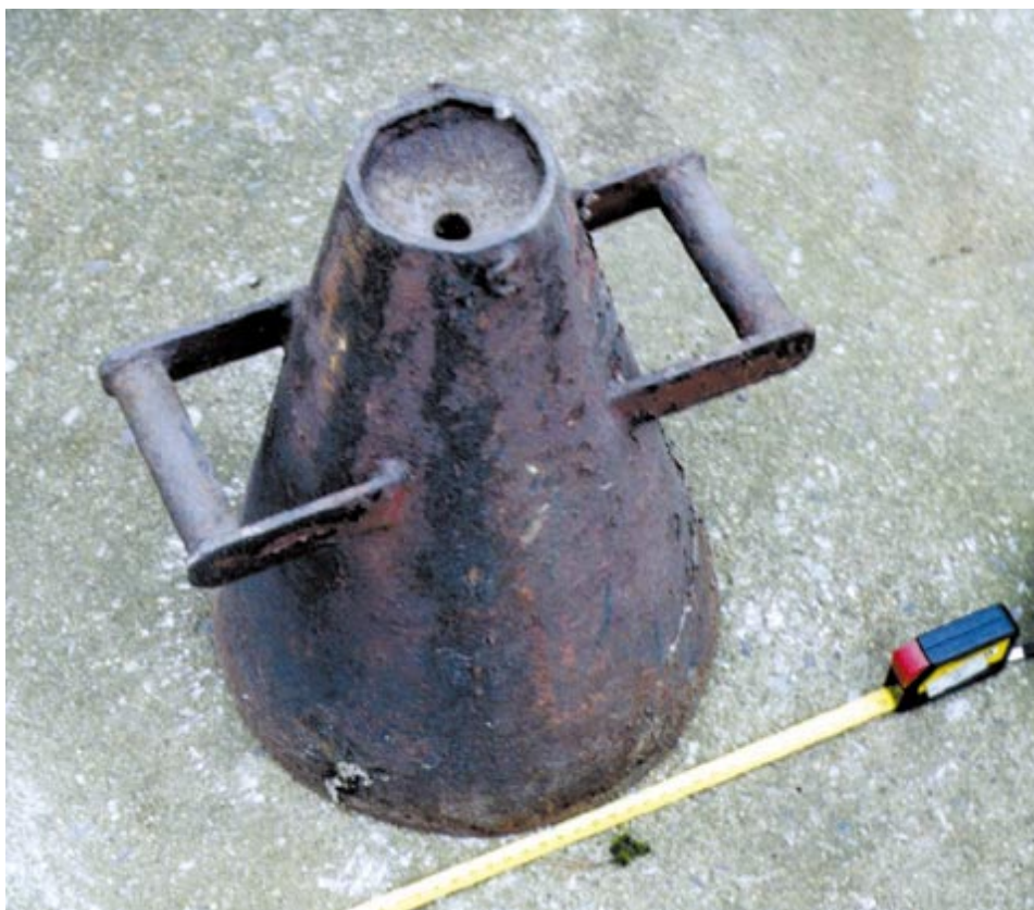
Obr. 4.26 Kuželovitý kontejner, který měl snad sloužit jako přepravní, ale vzhledem ke své hmotnosti okolo 70 kg byl používán nejspíše jen pro dočasné odkládání tyče s defektoskopickým zářičem (viz např. obr. 4.17). Průměr podstavy 27 cm, výška 38 cm. Ocelový plášť, olověné stínění
