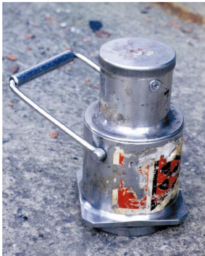
Obr. 6.12 Přepravní kontejner některého malého typu UK, nejspíše jde o UK-2. Stínění z ochuzeného uranu
