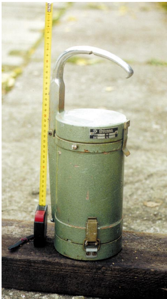
Obr. 5.3 Přepravní kontejner Chirana M 6102. Používal se pro přepravu lékařských zářičů, včetně kapalných, a pro přepravu vzorků vody z primárních okruhů jaderných elektráren. Olověné stínění, hmotnost 31 kg. Zvláštností tohoto kontejneru je oddělitelné dno
