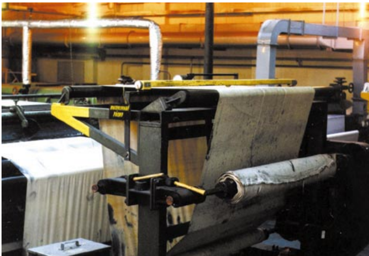
Obr. 1.3 Eliminátor elektrostatického náboje (žlutá tyč nahoře) na potěrací stroji pro pogumování tkanin. Silný alfa zářením se s povrchu tkaniny odstraní elektrostatický náboj a sníží se nebezpečí výbuchu par používaných rozpouštědel
