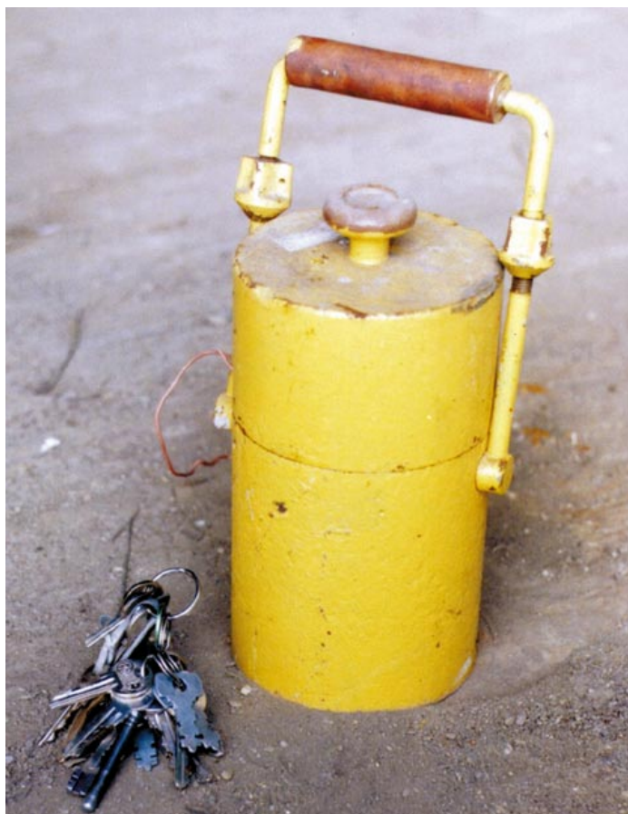
Obr. 6.46 Starý typ přepravního kontejneru. Olověné stínění. Barva není původní
