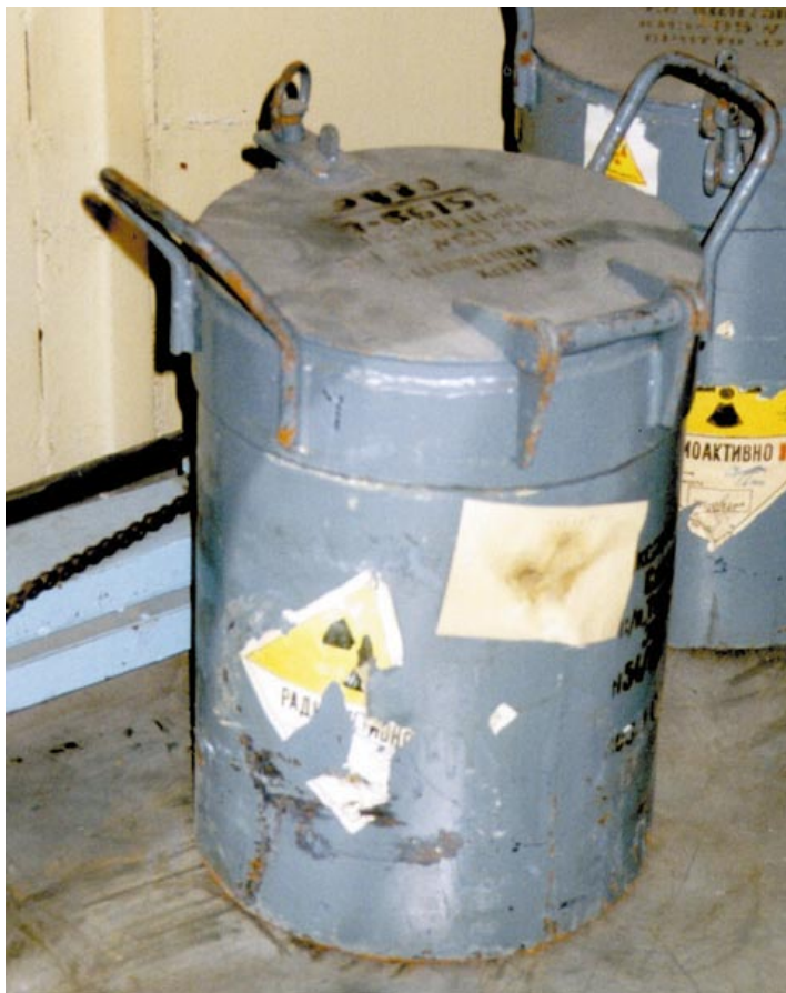
Obr. 6.36 Přepravní nádoba kontejneru KIZ sovětské výroby. Rozměry 26x36 cm, hmotnost 87 kg
