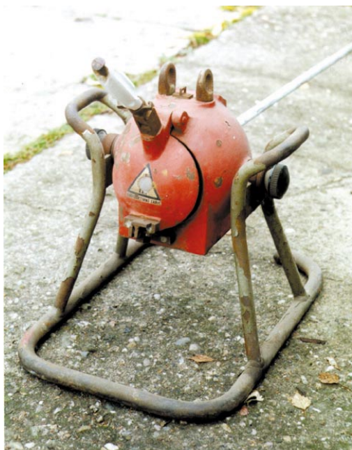
Obr. 4.16 Defektoskopický přístroj z r. 1962 typu OK 0.5. Pracovní kryt je výkyvný, zářič ^{137}\text{Cs} se vysouvá na tyči zezadu. Výrobce: První brněnská strojárna, Z.K.G. Hmotnost i s podstavcem okolo 55 kg
