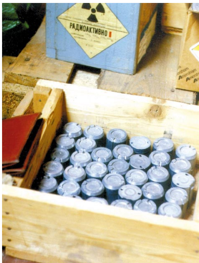
Obr. 6.49 Vnitřní olověné kontejnerky pro zářiče o aktivitě do stovek kBq
