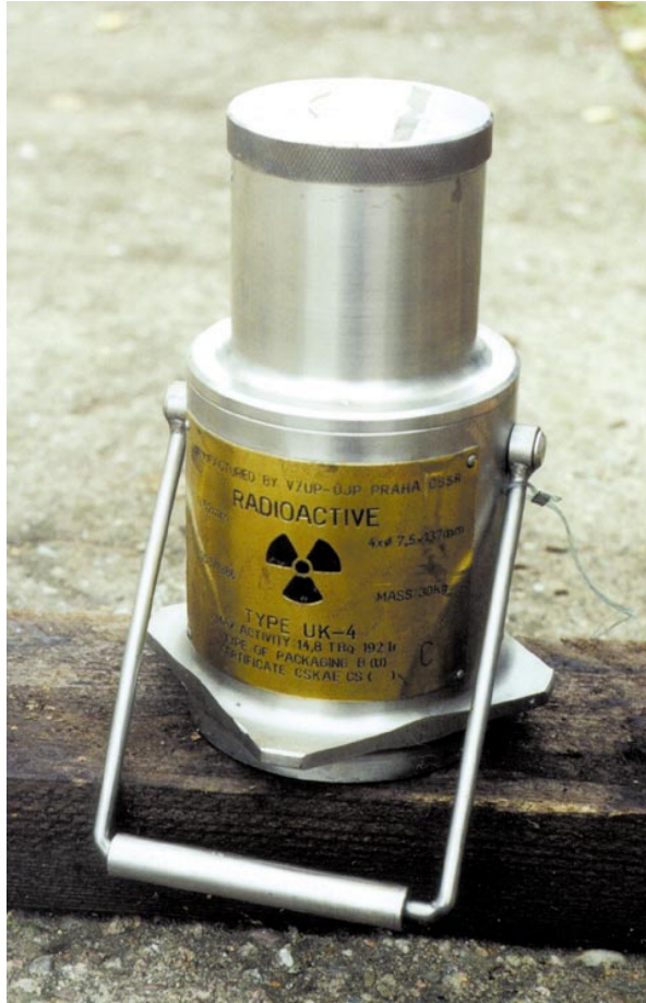
Obr. 6.15 Přepravní kontejner UK-4. Určen pro přepravu max. 14,8 TBq 192Ir (defektoskopické zářiče). Výška 27 cm, stínění 52 mm U, hmotnost 30 kg. Kontejner se již nesmí používat, nahradil ho UKI-4-135
