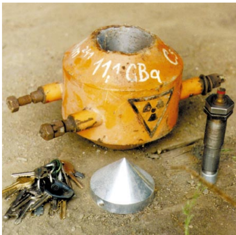
Obr. 3.21 Provozní kontejner zářiče popeloměru tuzemské výroby, byl však hojně používán i do jiných zařízení. Velikost 20 cm, hmotnost 25 kg
