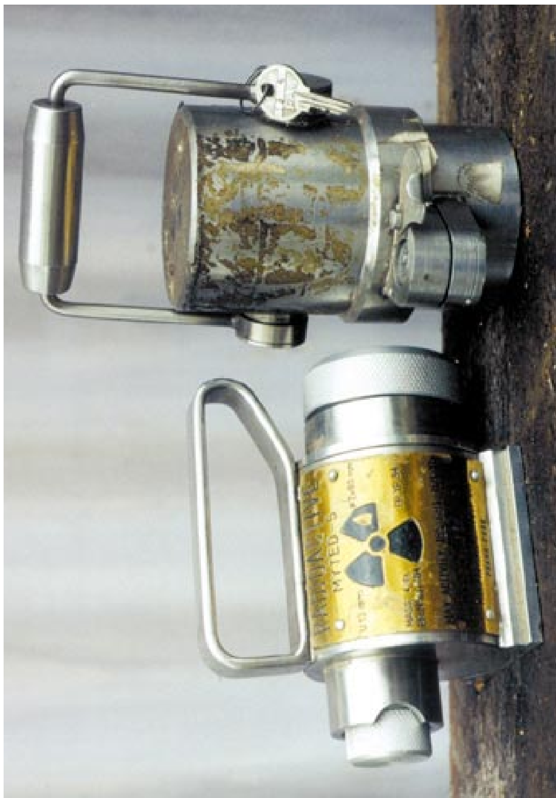
Obr. 4.7 Československý defektoskop MYTED-5 a přepravní kontejner pro jeho zářiče - typ GP-Yb-3x5. Defektoskop má 13 mm uranové stínění a hmotnost 4,75 kg. Jako zářič se v něm používá 169Yb o aktivitě max. 185 GBq. Kontejner má 15 mm U stínění, hmotnost 5 kg a smí obsahovat nejvýše 3x185 GBq 169Yb
