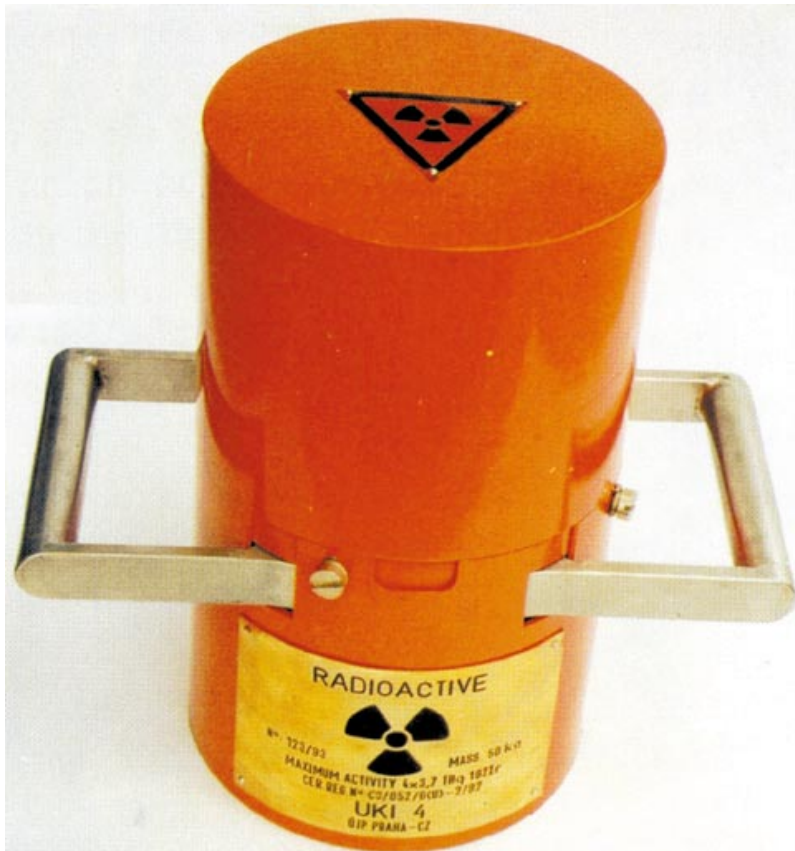
Obr. 6.18 Přepravní kontejner třídy B, typ UKI-4-135 v transportním obalu. Uranové stínění, 17x28 cm, hmotnost 50 kg. Max. aktivita 4x3.7 TBq 192Ir. Firemní materiál ŠKODA - ÚJP, Praha, a.s.
