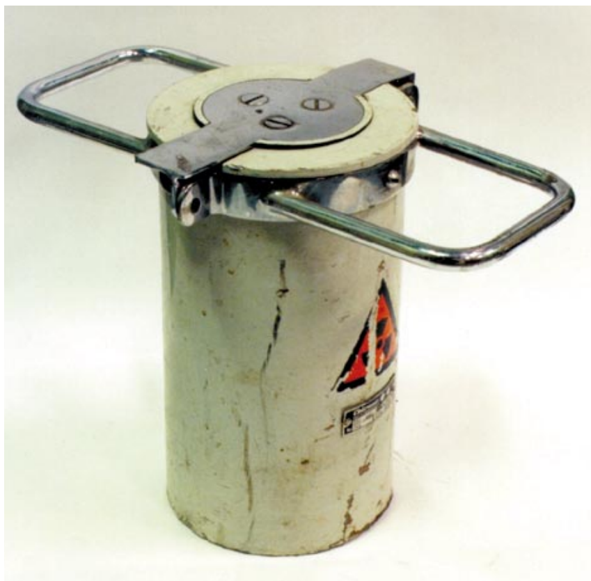
Obr. 5.5 Olověný přepravní kontejner, typ Chirana 392, výroba okolo r. 1970. Výška 26 cm, průměr 14 cm, hmotnost 42 kg
