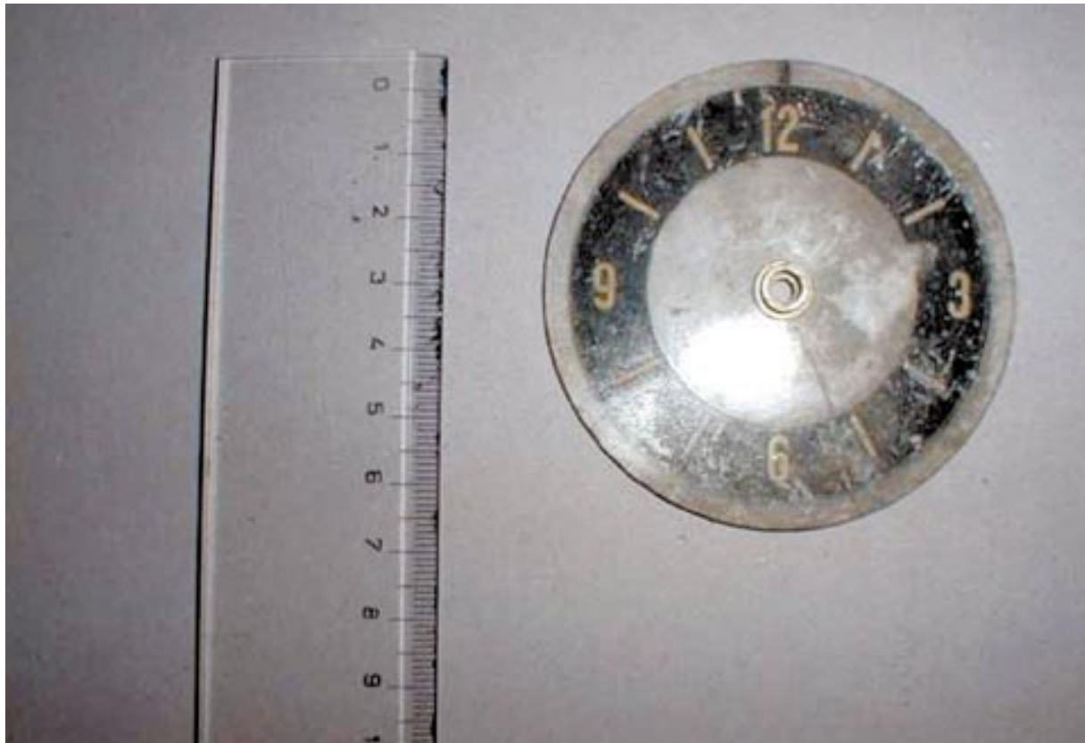
Obr. 7.3 Polotovar hodinového ciferníku s nanesenou luminiscenční barvou obsahující ^{226}\text{Ra} a ^{90}\text{Sr} nalezené v komunálním odpadu. Aktivita - řádově MBq, dávkový příkon v kontaktu 100-300 xGy/h. Foto SÚRO
