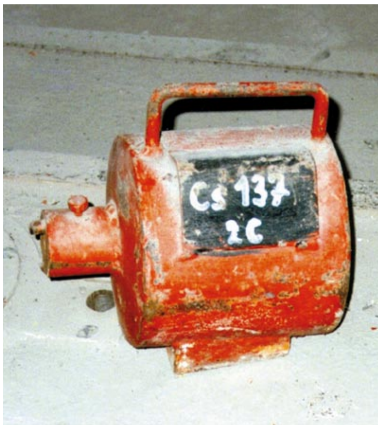
Obr. 3.36 Neurčený provozní kontejner. Podle nápisu byl v něm používán zářič ^{137}\text{Cs} o aktivitě možná 74 GBq
