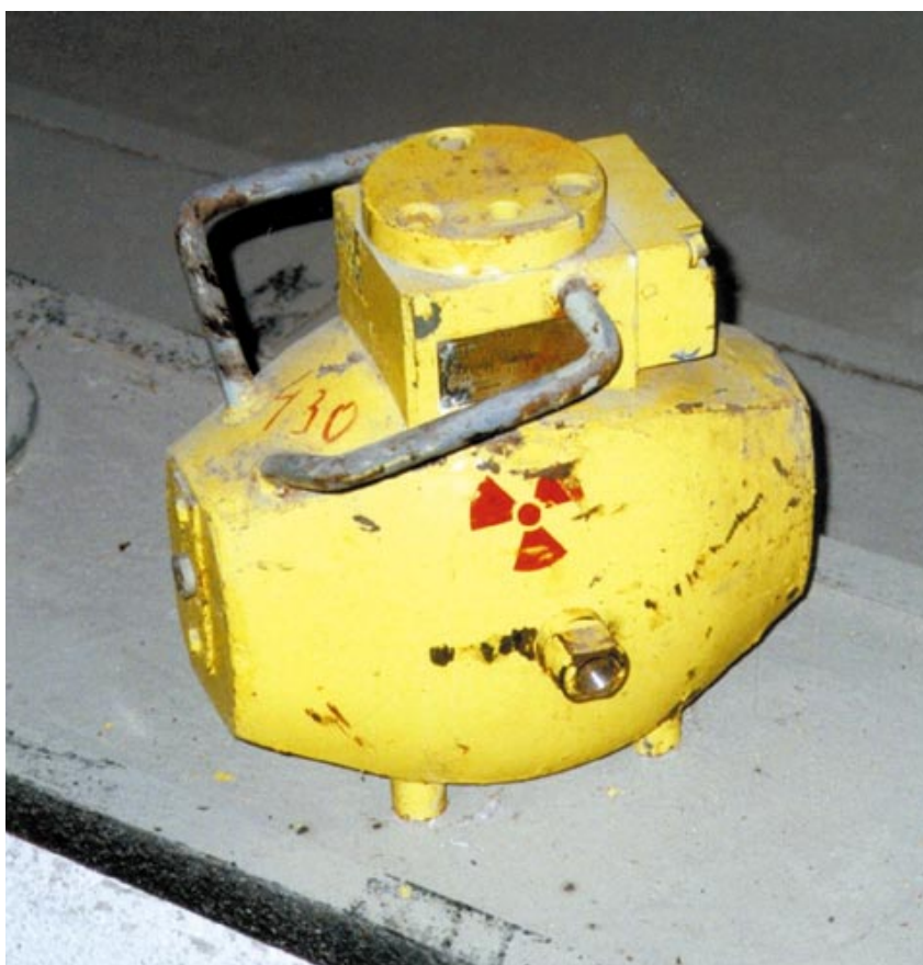
Obr. 3.34 Polský provozní kontejner PrO-100 s Pb stíněním. Hmotnost 80 kg
