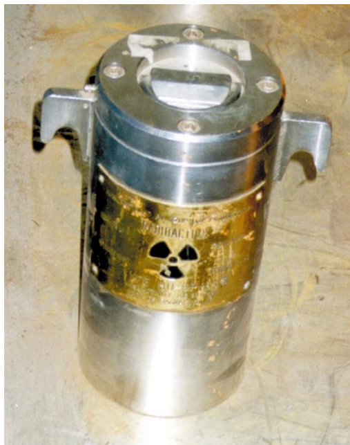
Obr. 6.1 Přepravní kontejner HU-GP-65 staršího data výroby - úchyty po stranách. Rozměry 13x31 cm, hmotnost 45 kg. Výrobky ÚJP Praha
