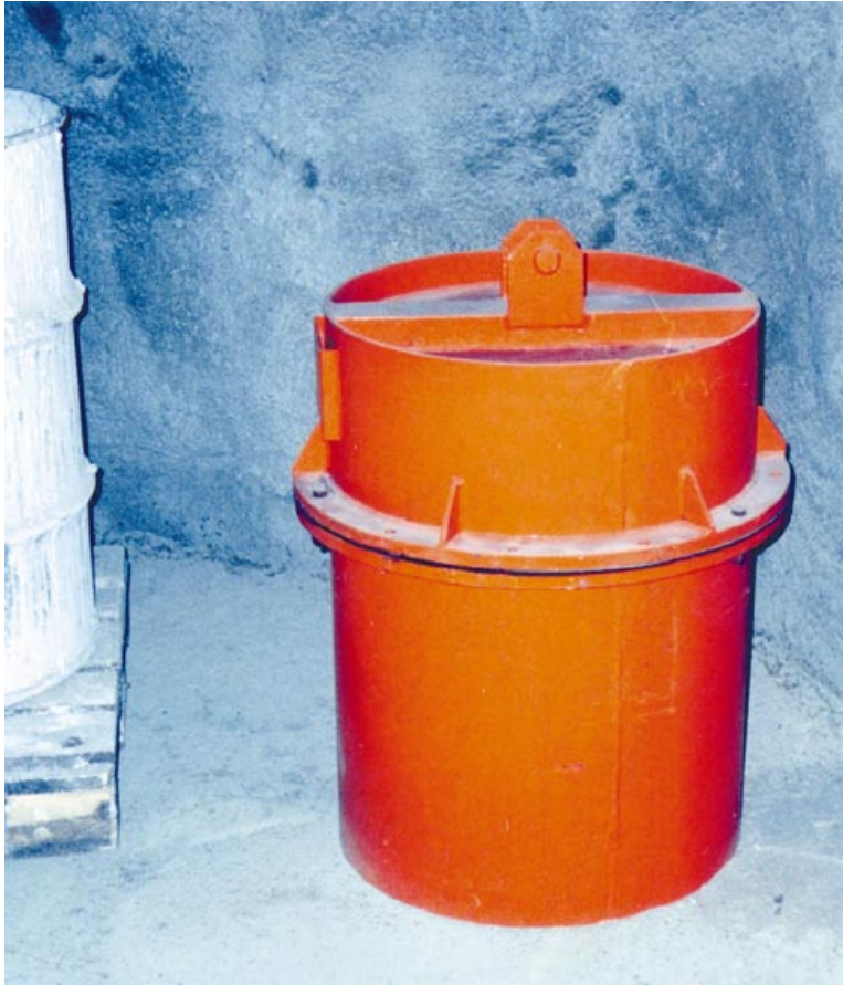
Obr. 6.40 Prototyp přepravního obalu pro velké kontejnery. Průměr cca 35 cm
