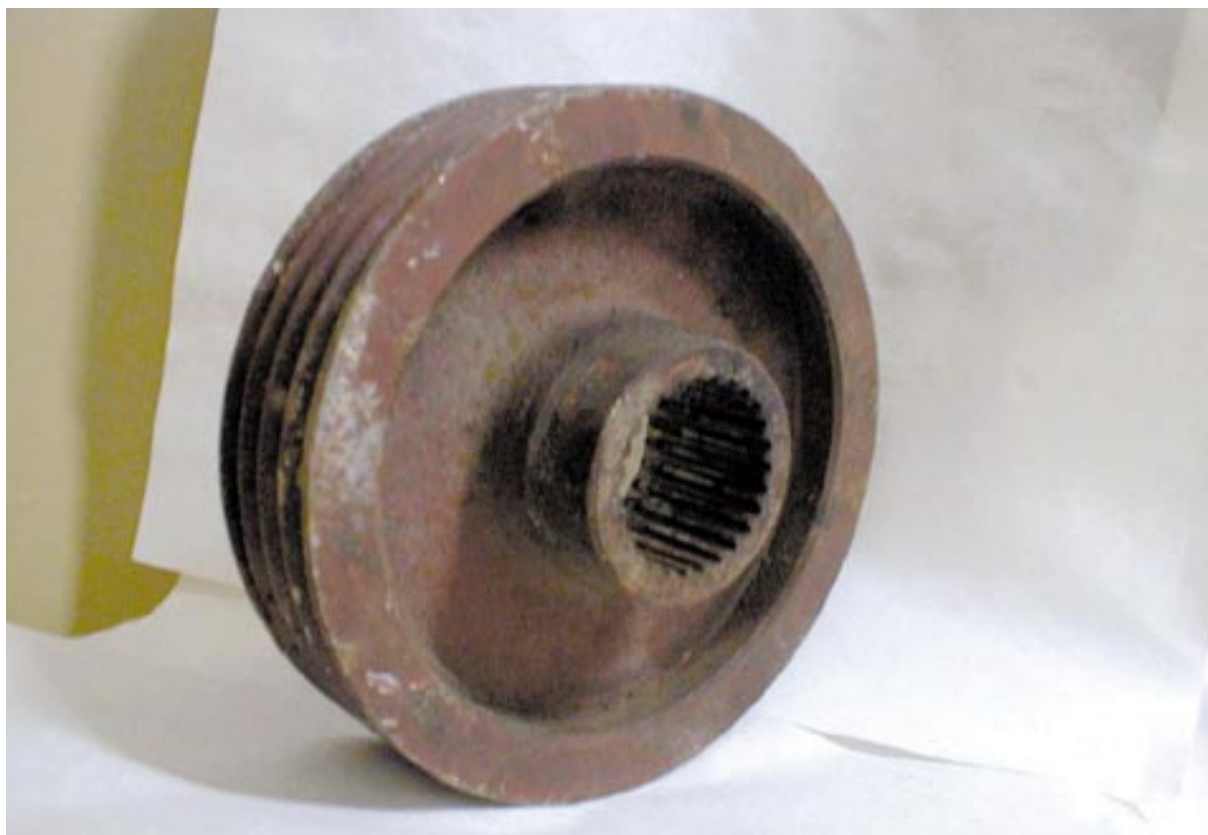
Obr. 7.11 Hutnické výrobky kontaminované ^{60}\text{Co} z náhodně roztavených zdrojů. Aktivity v rozmezí desítek kBq/kg až desítek MBq/kg, dávkové příkony v kontaktu 1-100 xGy/h. Řemenice. Foto SÚRO
