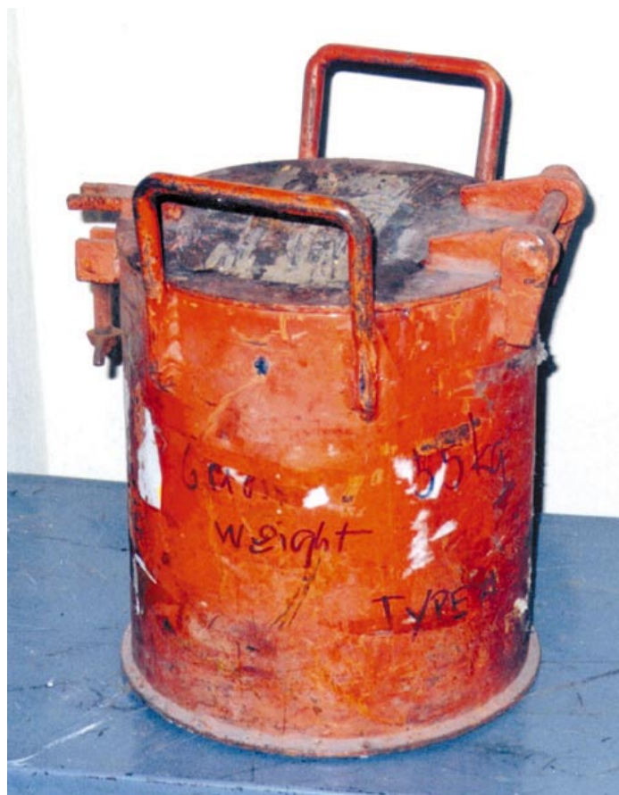
Obr. 6.35 Přepravní sud na kontejner sovětské výroby. Barva není původní. Rozměry cca 25x40 cm, hmotnost 55 kg
