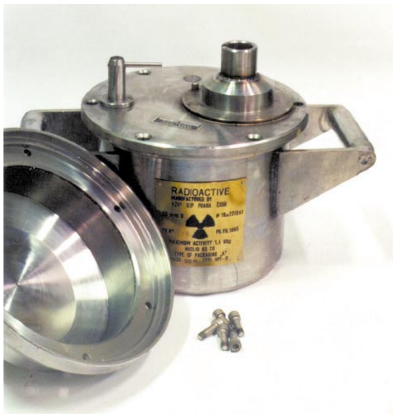
Obr. 6.29 Přepravní kontejner HPT-6 v otevřeném stavu. V popředí 5 hnízdových pouzder
