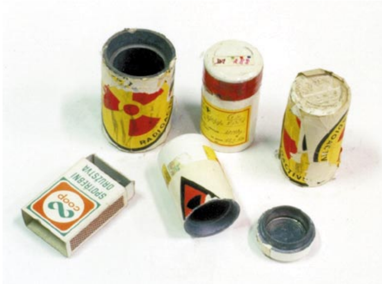
Obr. 6.53 Malé olověné krabičky o rozměrech 6,5-8,0 x cca 4 cm, používané pro dodávky ^{90}\text{Sr}
