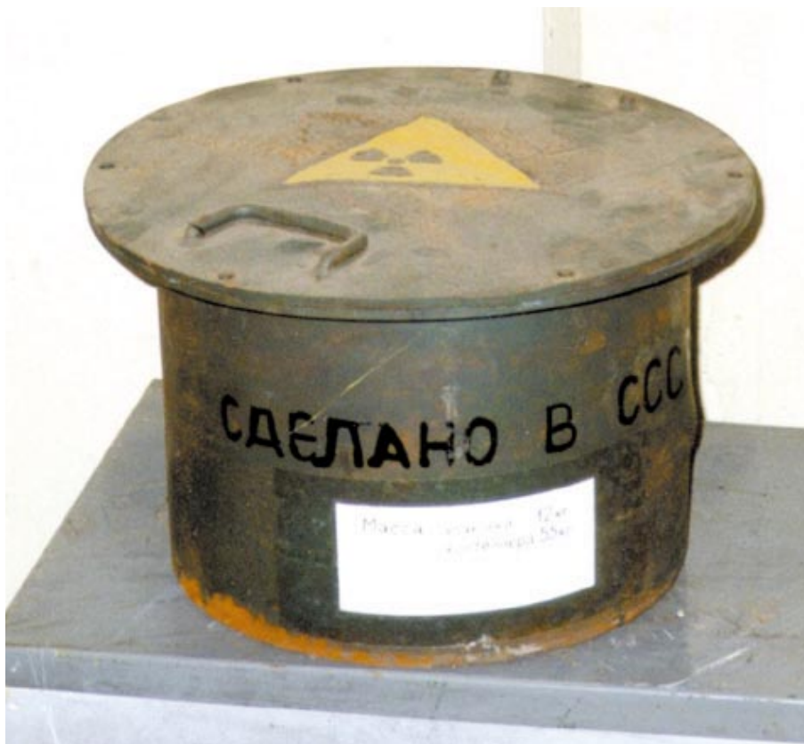
Obr. 6.38 Torzo přepravního sudu na kontejner sovětské výroby. Na štítku je uvedena hmotnost sudu 12 kg, kontejneru 55 kg
