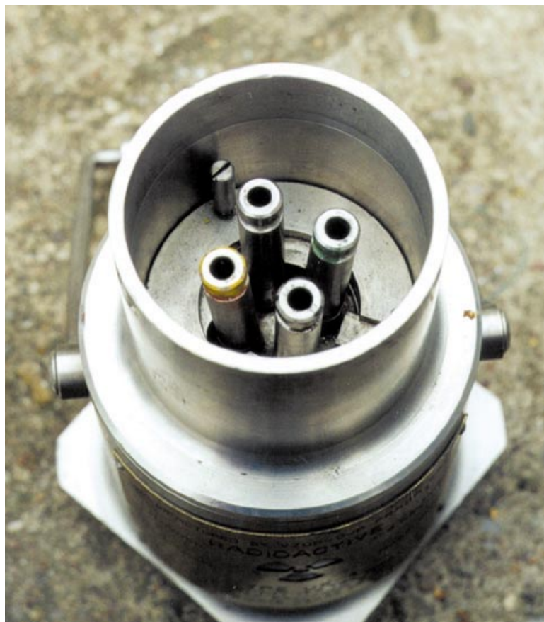
Obr. 6.16 Uvnitř přepravního kontejneru UK-4 se nacházejí 4 hnízdová pouzdra o průměru 7,5 mm a délce 137 mm
