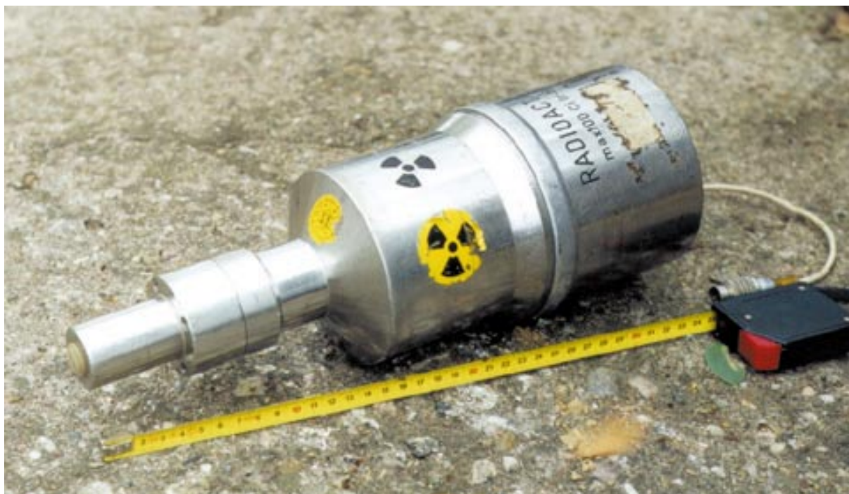
Obr. 4.8 Defektoskop M18 "Molch" ("velký Mlok") pro kontrolu svarů plynovodů apod. Při práci je umístěn na dálkově ovládaném vozíku (viz obr. 4.12), který zajišťuje pohyb v potrubí. Zářič ^{192}\text{Ir} , max. 3,7 TBq. Stínění je uranové
