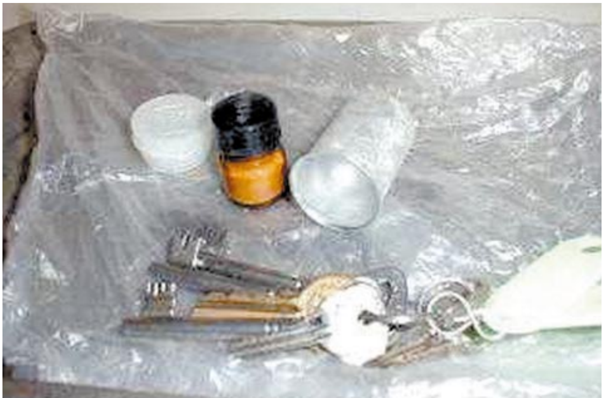
Obr. 7.2 Další příklad luminiscenční barvy obsahující ^{226}\text{Ra} nalezené v komunálním odpadu. Foto SÚRO
