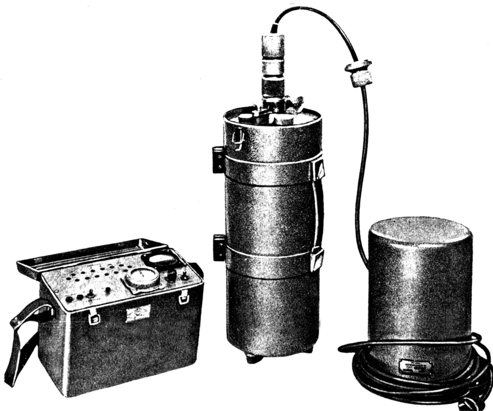
Obr. 3.27 Starý sovětský karotážní vlhkoměr pro mělké vrty typu GGP-1. Zářičem je ^{137}\text{Cs} . Sonda má rozměry 5x50 cm a hmotnost 3 kg. Foto: katalog Izdělja jadernogo priborostrojenija stran-členov SEV
