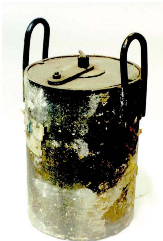
Obr. 6.37 Starší přepravní kontejner KIZ sovětské výroby, již bez označení. Ocelový obal, olověné stínění, rozměry válce 22x30 cm, hmotnost cca 100 kg
