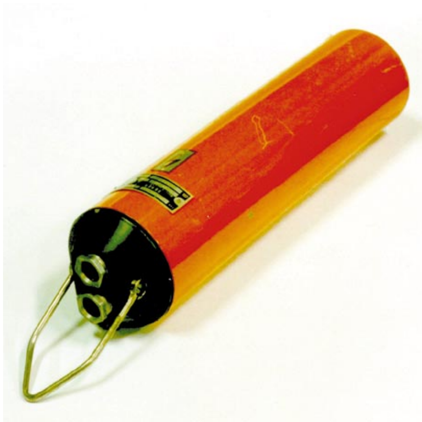
Obr. 3.10 Sonda MKD 103 k indikátoru úrovně hladiny a polohy. Sonda sama zářič neobsahuje, ale může být kompletována s kterýmkoliv zdrojem záření z výroby bývalé Tesly Liberec: MDG 300, MDG 301 nebo MDG 201
