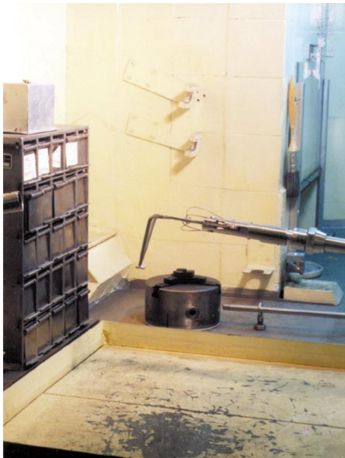
Obr. 1.9 Vnitřek polohorké komory. V pozadí dálkově ovládaná soustruhová hlava, sloužící k upnutí zářiče.
