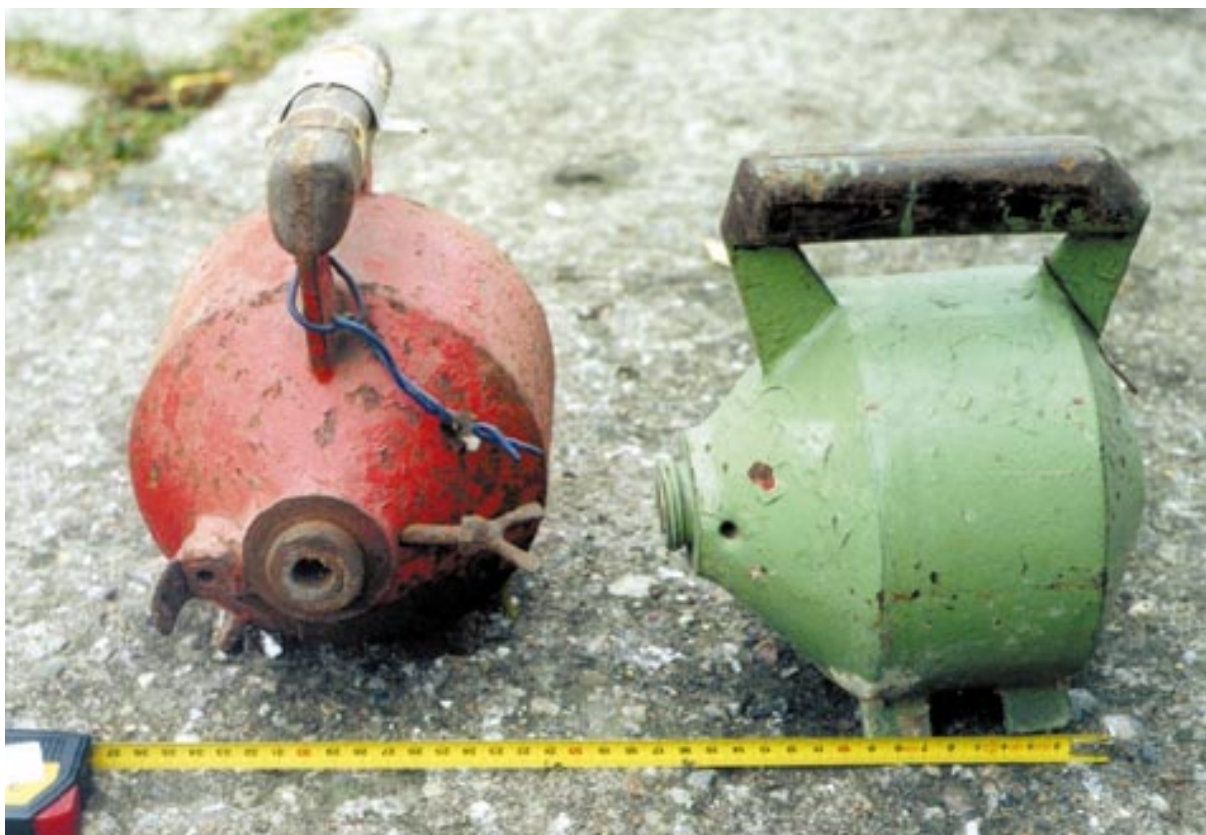
Obr. 4.24 Historické přepravní i provozní kontejnery pro defektoskopii. Větší a těžší (cca 27 kg) obdoba "vajiček", vyobrazených na obr. 4.19 a 4.20. Možná sloužily jen dopravě, neboť vnitřní kanál není průchozí
