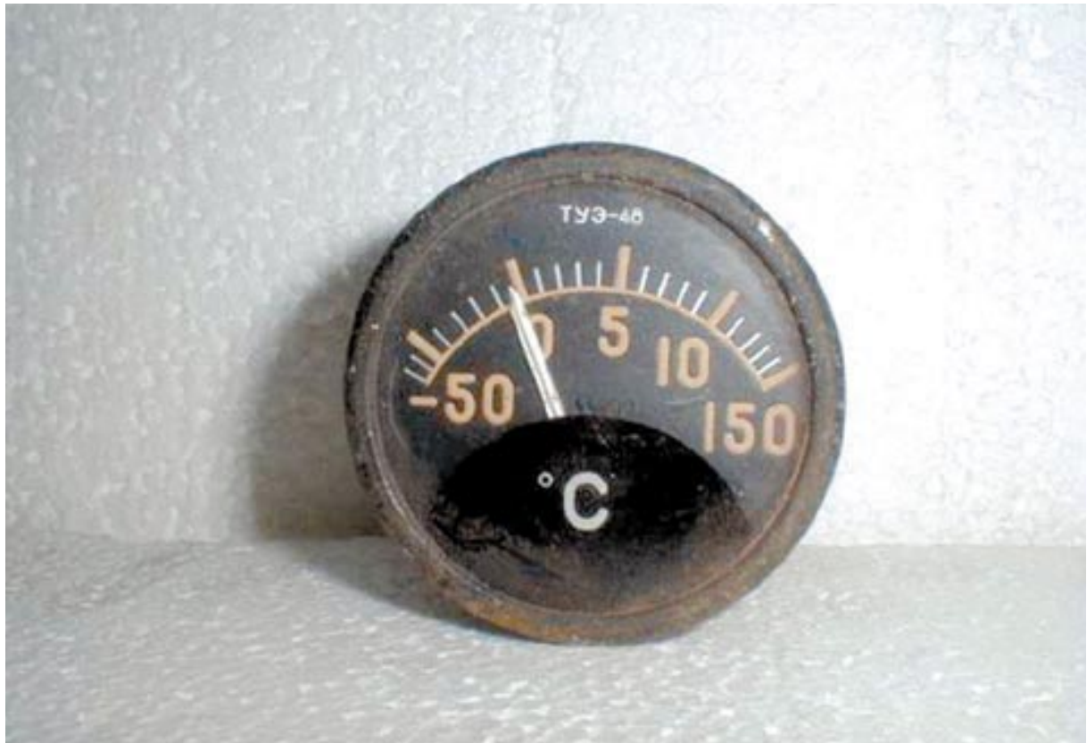
Obr. 7.5 Vojenský přístroj s nanesenou luminiscenční barvou obsahující ^{226}\text{Ra} nalezený v kovovém šrotu. Aktivita 50-500 kBq, dávkový příkon v kontaktu 1-10 xGy/h. Foto SÚRO
