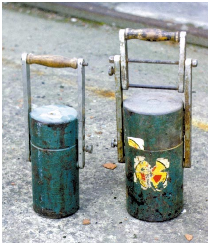
Obr. 6.44 Olověné přepravní kontejnery na zářiče OK-25 a OK-35. Výška cca 30 cm, hmotnost 25 a 35 kg. Výrobek ÚJP Praha
