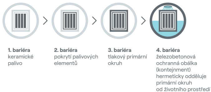
Principiální schéma ochranných bariér jaderné elektrárny
