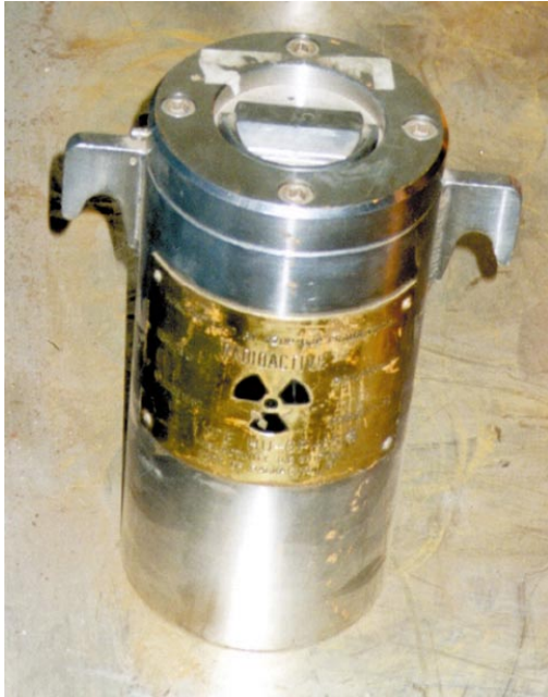
Obr. 6.1 Přepravní kontejner HU-GP-65 staršího data výroby – úchyty po stranách. Rozměry 137x31 cm, hmotnost 45 kg. Výrobky ÚJP Praha
