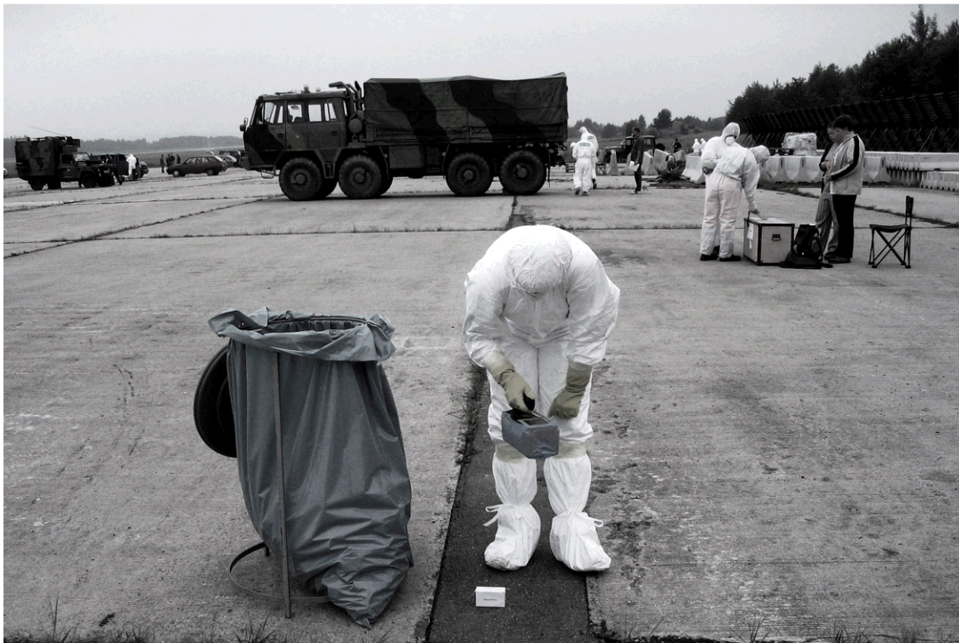
Obr. 4b Měření příkonu dávkového ekvivalentu v rámci cvičení „Terorista 2006“
