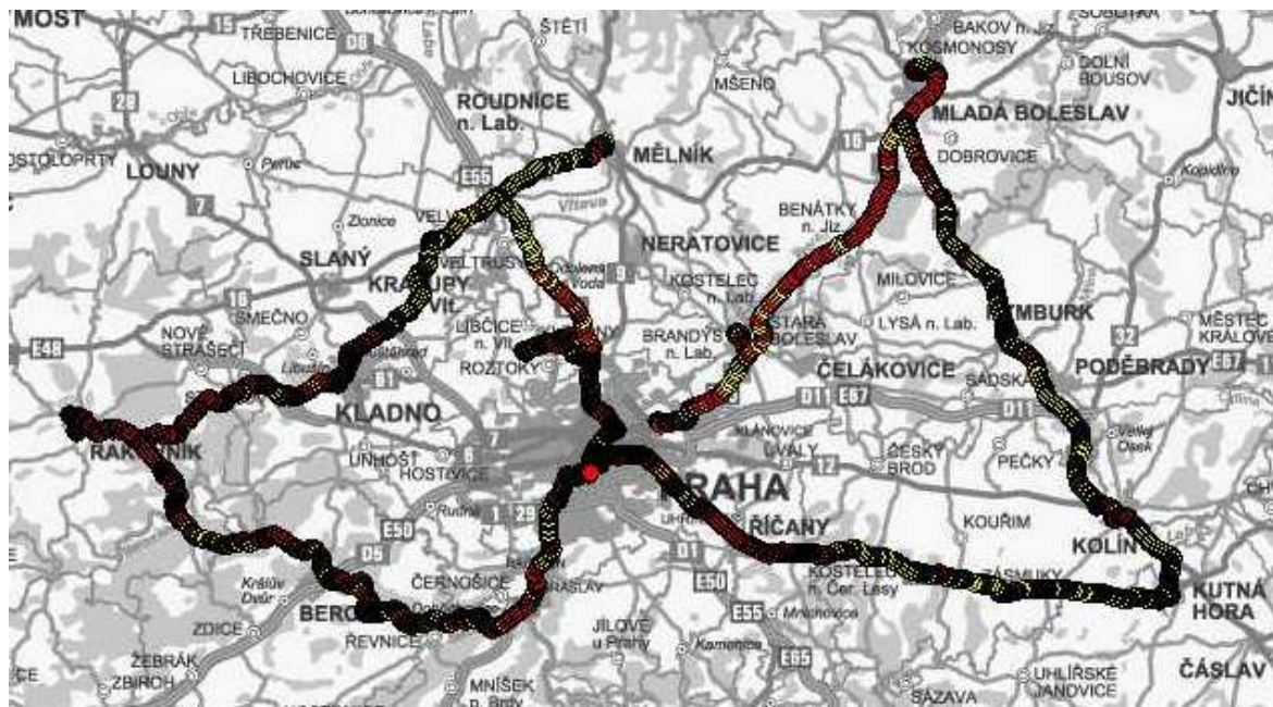
Obr. 4a Měření příkonu dávkového ekvivalentu při pojezdových měřeních v rámci výměny TL dozimetrů prováděné MS (měření SÚRO Praha)
